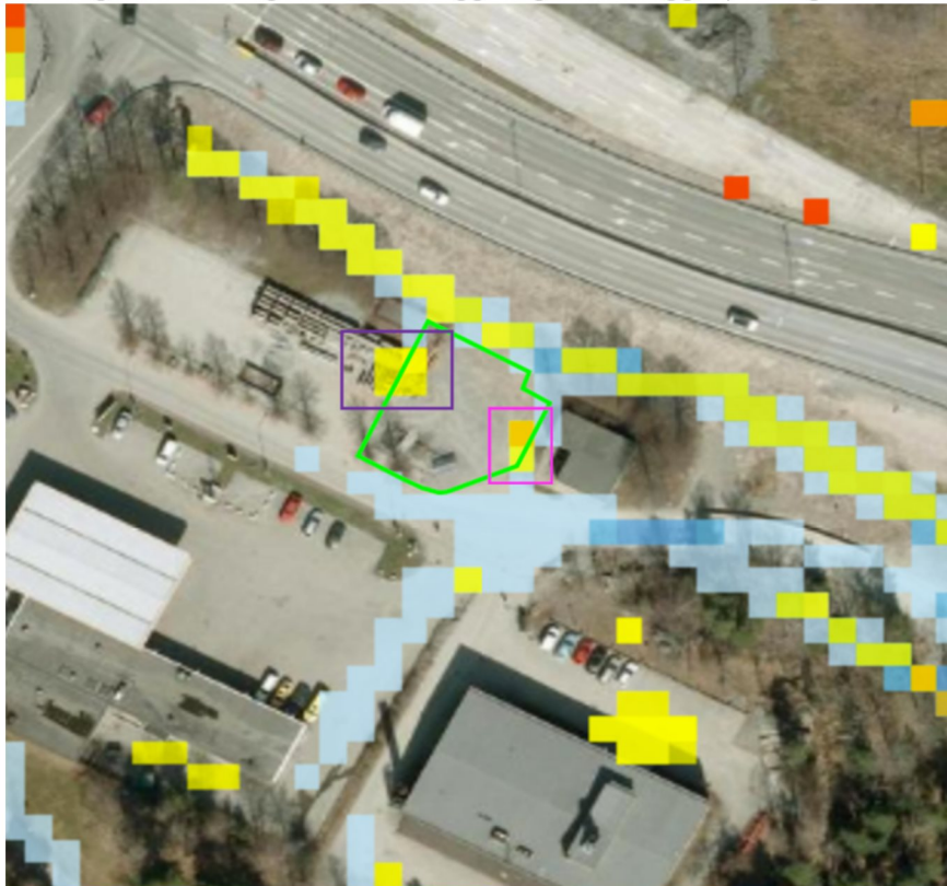
Figur 12. Bild från Stockholms stads skyfalls modell med de två riskområdena markerade i lila och rosa. Blått visar vattnets flödesvägar över området, Röd-gula färger visar på hur djupt vatten som kan ansamlas i vattenvägar och lågpunkter vid 100 års regn med klimatfaktor. Fastighetsgränsen är markerad med grön linje.
