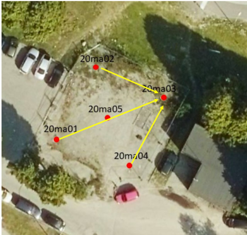
Figur 4. Bild över provtagningspunkter för markprovtagning. Gula pilar visar på ytlig avrinning.
