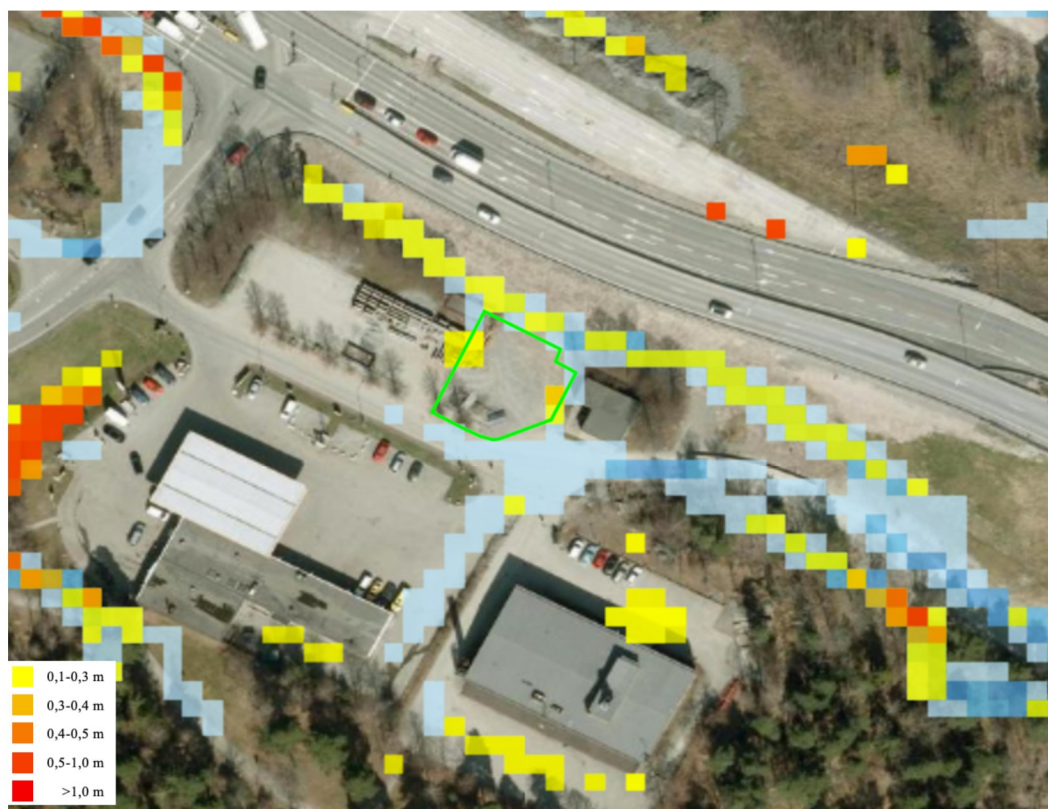
Figur 11. Bild från Stockholms stads skyfallsmodell. Blått visar vattnets flödesvägar över området, Röd-gula färger visar på hur djupt vatten som kan ansamlas i vattenvägar och lågpunkter vid 100 års regn med klimatfaktor. Fastighetsgränsen är markerad med grön linje.
