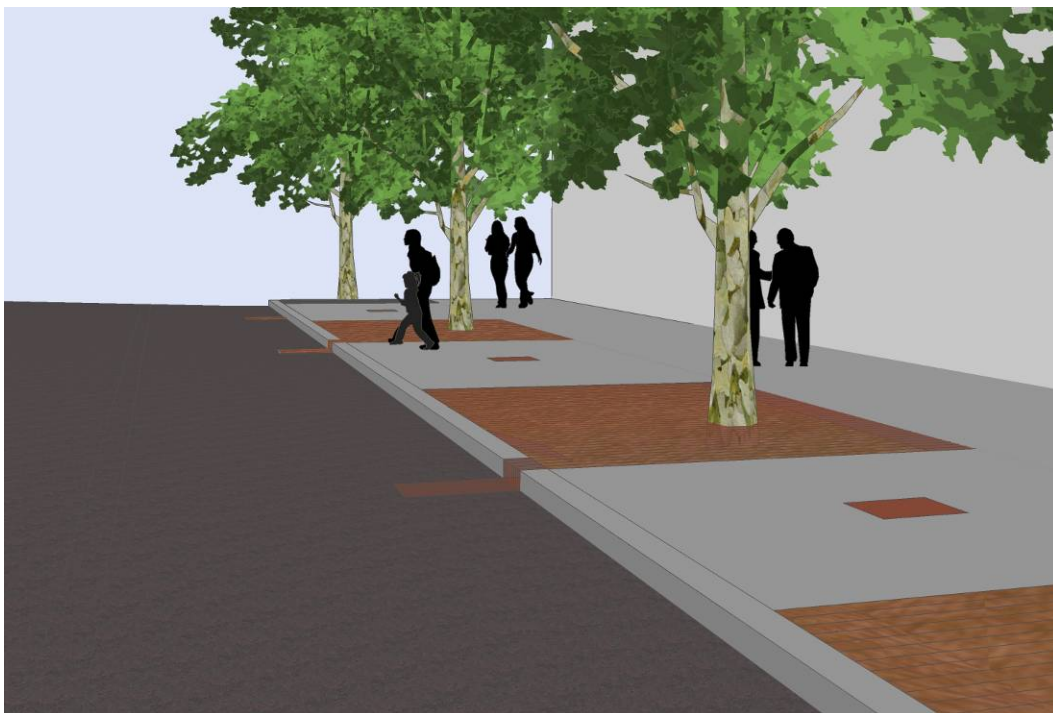
Bild 11. Erik Dahlbergsgatan. Inloppsbrunnar enligt samma princip som för lokalgatan. Luftbrunnar mellan trädgroparna kan föra ned dagvatten till emellanliggande kross.
