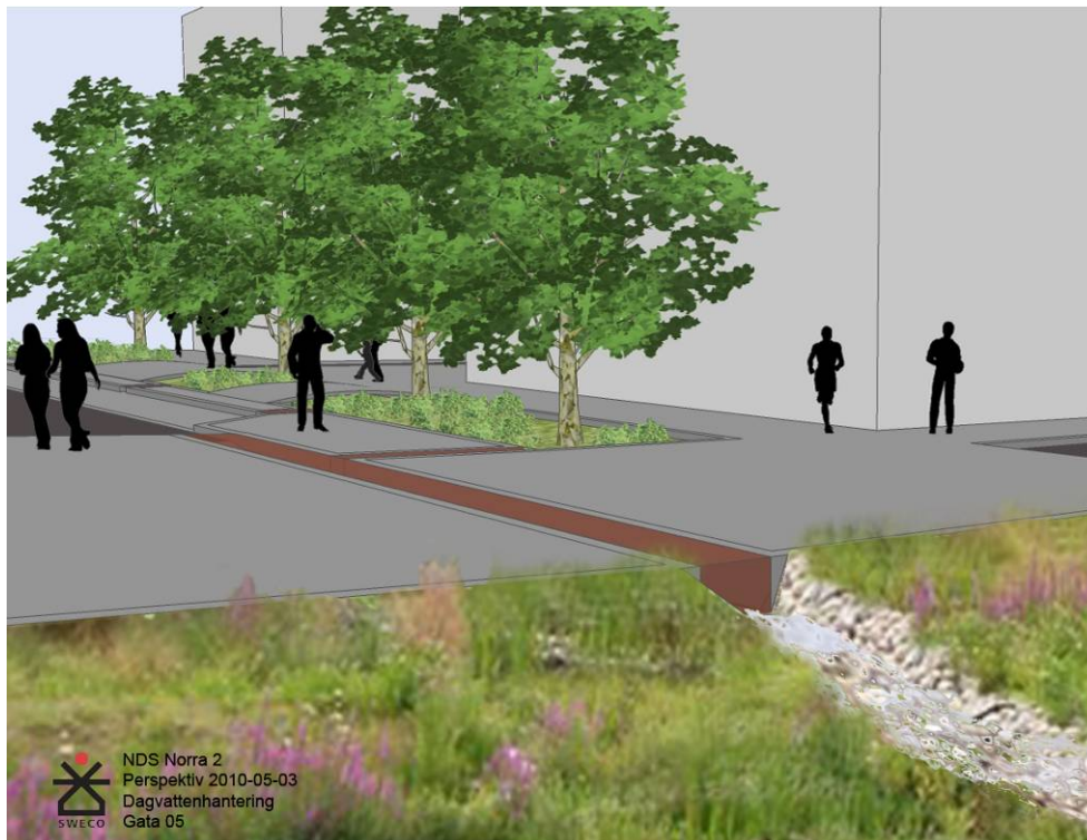
Bild 4. Lokalgata. Bräddränna som tar vatten ifrån lokalgatans växtbädd. Rännan mynnar i fuktstråk i park vid Husarviken. Alternativet till bräddränna är brunnar och tät bräddledning, vilket visas i planskiss.
