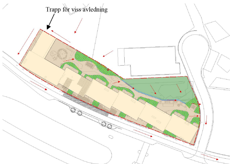
Figur 15. Sekundära avrinningsvägar (röda pilar) vid skyfall. Avskärande dike/ränn dal visas i blått.
