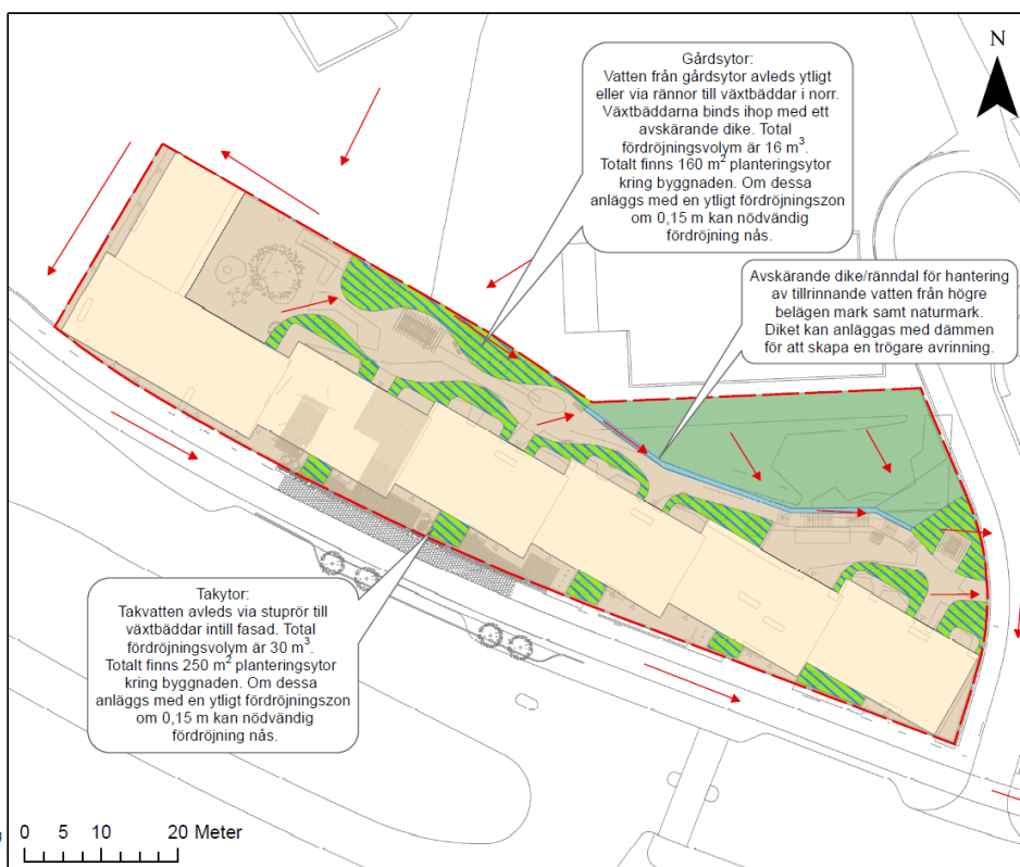
Figur Kvarter A. Föreslagen princip för dagvattenhantering. (Underlag: PM Dagvatten Kvarter A, Karlsviks strand, Björking 2021-06-08)
