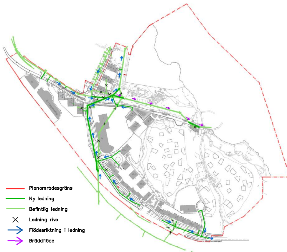
Figur 10. Föreslagen princip för framtida dagvattensystem. (Underlag från SVOA, hämtat 2022-05-02)
