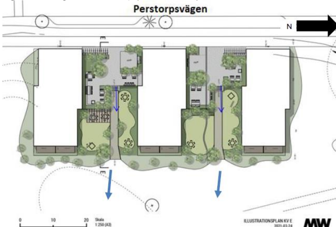
Figur Kvarter E. Sekundära avrinningsvägar utifrån höjdsättning visas med blå pilar. Grönytor som syns i figuren bedöms kunna anpassas för att kunna omhänderta dagvatten. Taken anläggs med gröna tak. (Underlag: Dagvattenutredning Karlsvik Kvarter E, Tyréns 2021-09-02)
