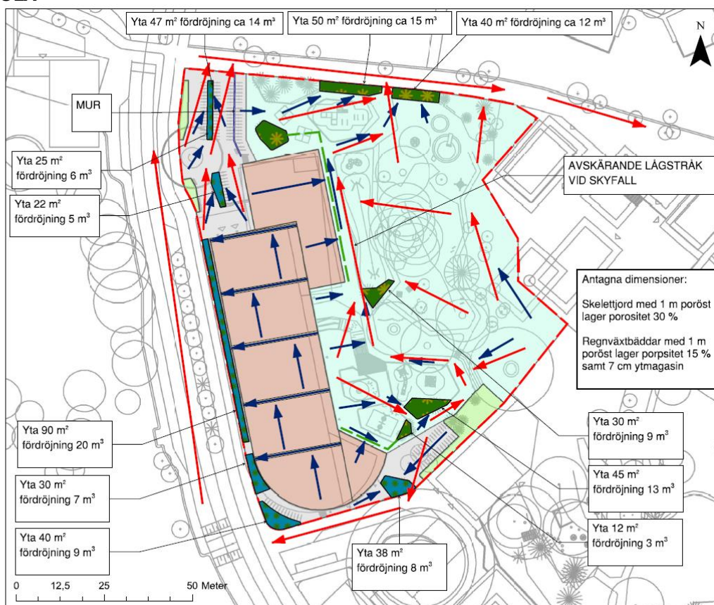
Figur Karlsviks skola. Föreslagen princip för dagvattenhantering. (Underlag: Dagvattenutredning för Karlsviks skola, Bejerkling 2021-06-29)
