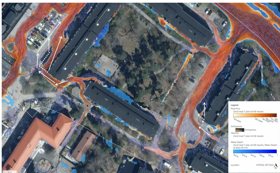
Figur 10-2. Skyfallsflöden vid 100-årsregn och förslag till anpassning av höjdsättning runt befintliga byggnader som ska byggas om i bottenplan. Förslag murar i streckad linje och pilar princip för höjdsättning för att vatten inte ska rinna in i nya entréer.
