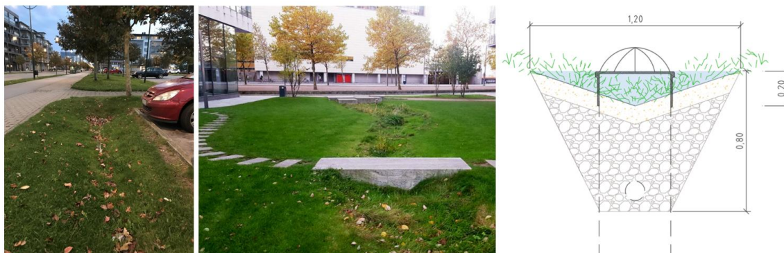
Figur 9-2. Principer och exempelbilder på infiltrationsstråk (Structor Mark Uppsala).
