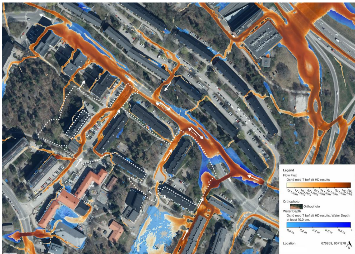
Figur 8-6. Maxflöde och maxdjup vid 100-årsregn i befintlig situation med påverkan av utbyggt Telestaden. Bilden visar inte ett specifikt tidssteg utan maxvärdet under simuleringstiden i varje punkt. Pilar visar flödesriktning, streckade pilar visar flödesriktning när lågpunkt i öst vid gångtunneln är full.
