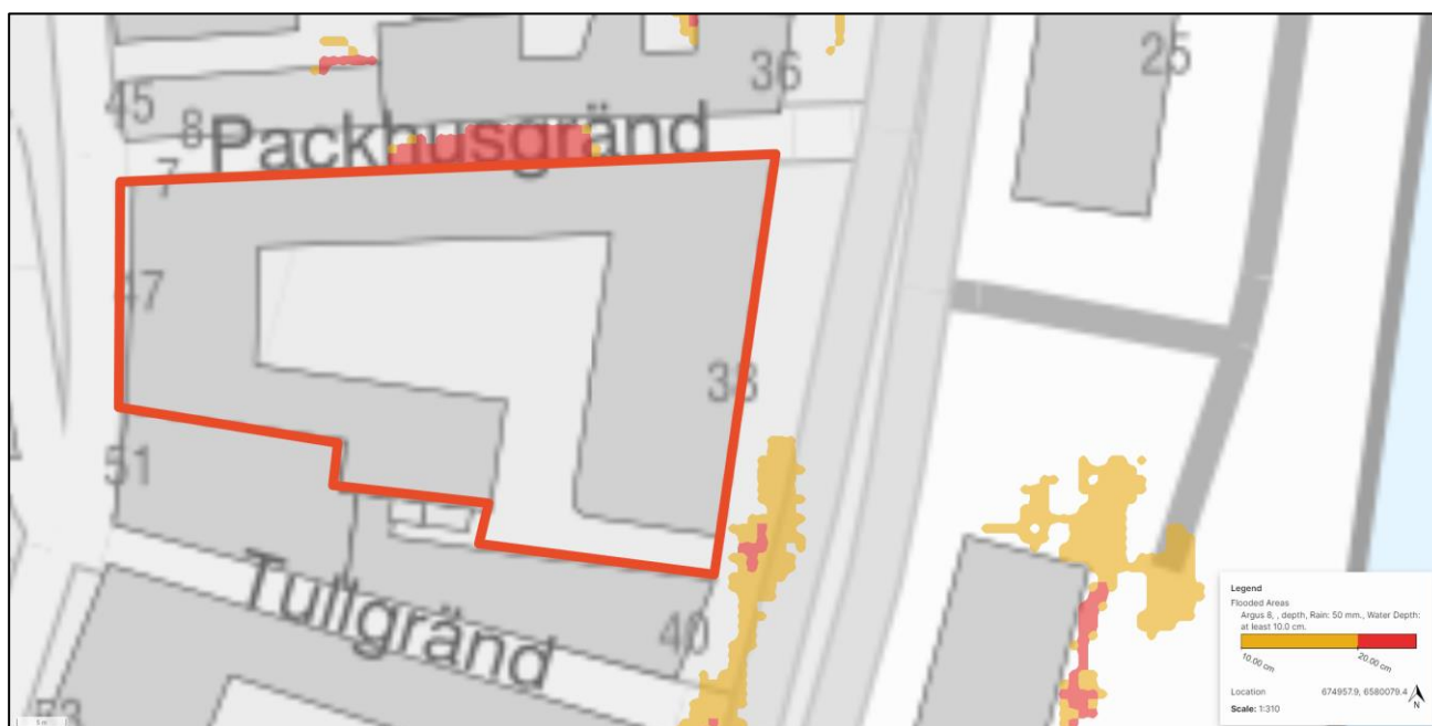
Figur 7.2 Modellering över översvämningsutbredning vid 50 mm regn. Visar vattenstånd på minst 10 cm. @Scalgo Live
