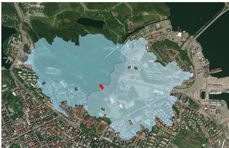
Figur 16. Delavrinningsområden för utredningsområdet med nuvarande vattenreservoar markerat i rött. Vita pilar markerar utlopp i till Husarviken och vidare till Lilla Värtan. Nederbörden motsvarar yttlig avrinning ett 100-års regn på 56 mm.
