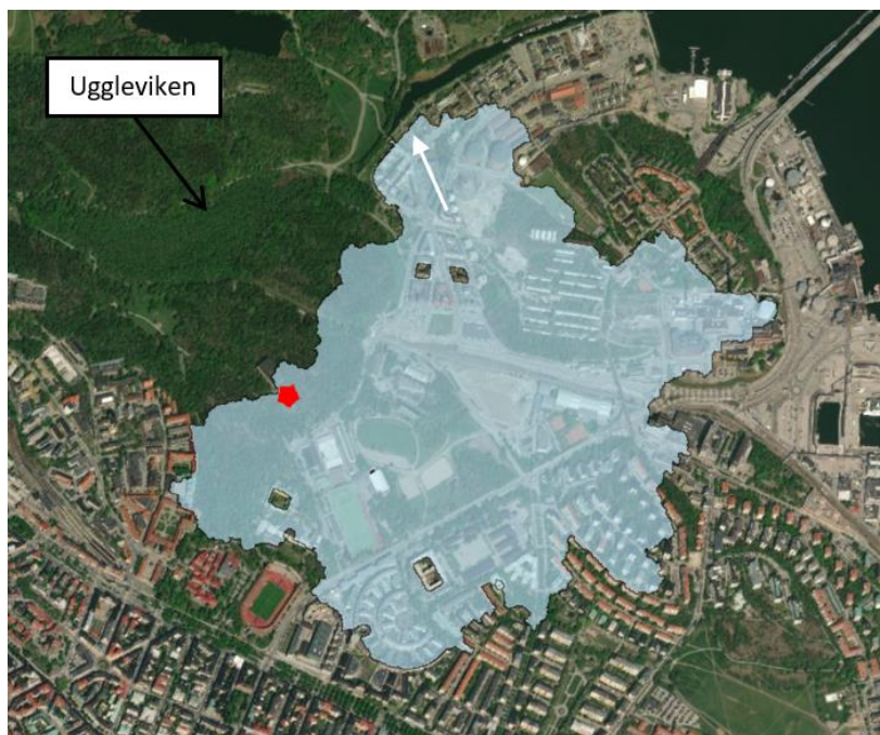
Figur 17. Delavrinningsområde för utredningsområdet med planerad vattenreservoar markerat i rött. Delavrinningsområdet har utlopp i Lilla Värtan via Husarviken markerat med vit pil. Nederbörden motsvarar ytlig avrinning vid ett 100-års regn på 56 mm.
