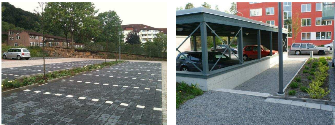
Figur 4 T.v. Parkeringsyta som avrinner till växtbädd. T.h. genomsläpplig grusgång och växtbädd.
