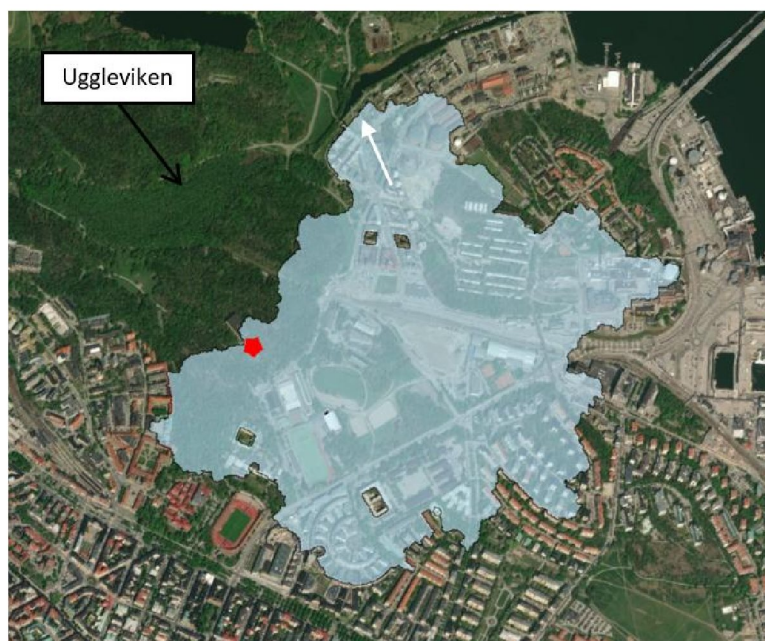
Figur 17. Delavrinningsområde för utredningsområdet med planerad vattenreservoar markerat i rött. Delavrinningsområdet har utlopp i Lilla Värtan via Husarviken markerat med vit pil. Nederbörden motsvarar yttlig avrinning vid ett 100-års regn på 56 mm.
