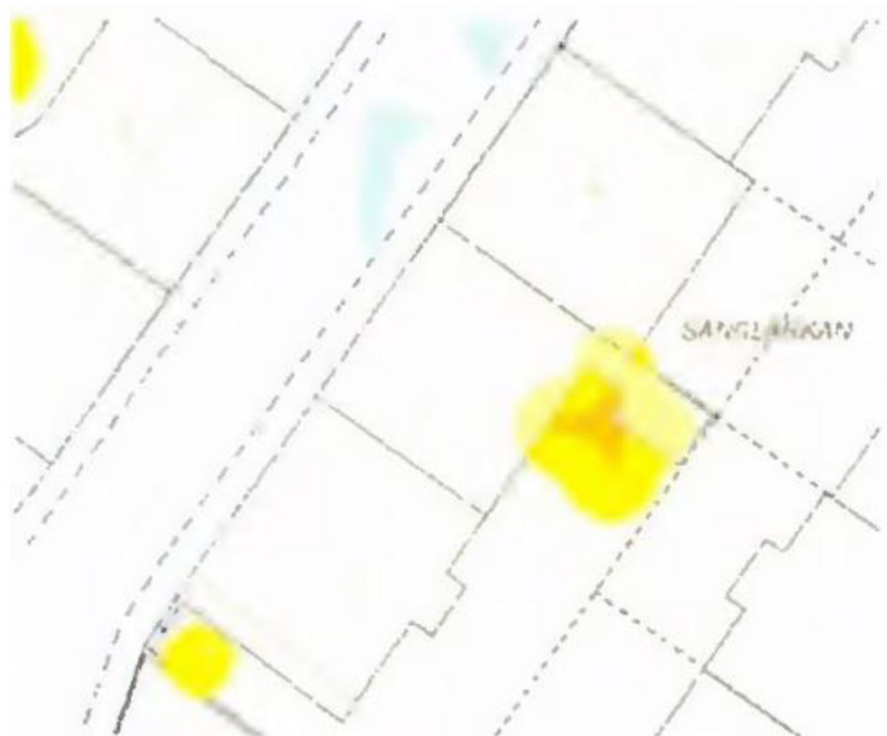
Figur 11 Urklipp ur stadens skyfallsmodell. Markering visar maximalt vattendjup där gult motsvarar 0,1-0,3 m och orange 0,3-0,4.
