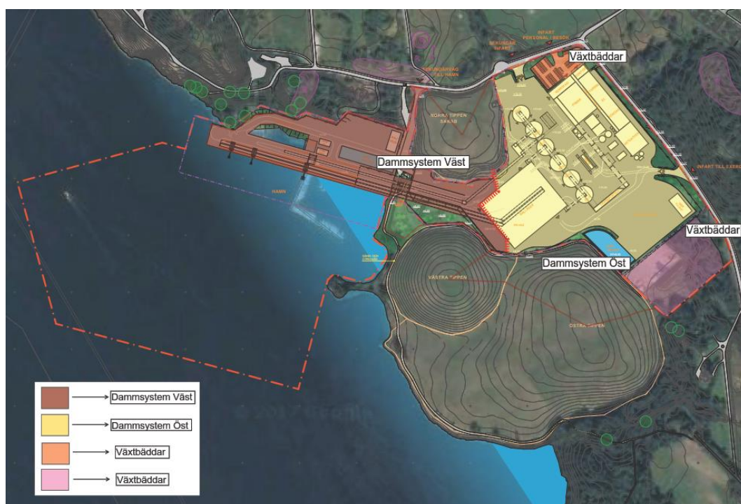
Figur 10 - Avrinningsområden till respektive föreslagna reningsanläggningar markeras med olika färger. Rött område avleds till dammsystem väst, gult område avleds till dammsystem öst och orangefärgat och rosa område avleds till växtbäddar. Röd streckad linje markerar vattendelare.
