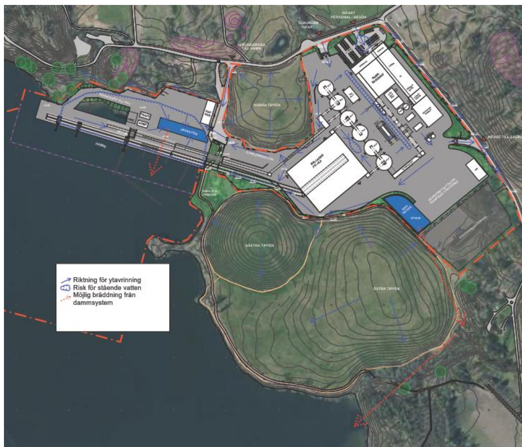
Figur 19 – Skyfallsscenario. Ytvavrinning, möjlig bräddning och risk för stående vatten är utmärkt i figuren.
