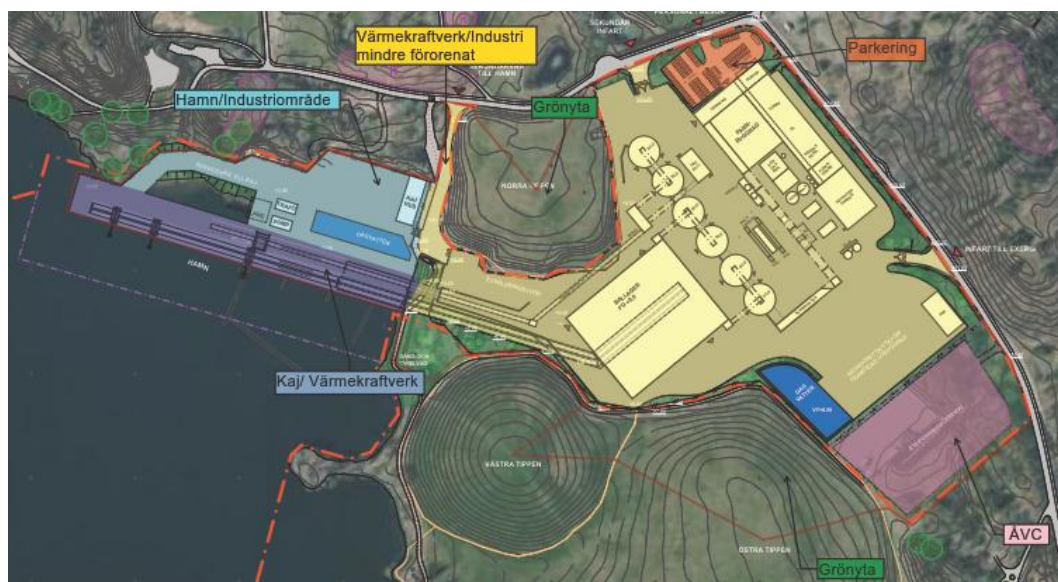
Figur 9 - Översikt över planförslaget med indelning utefter den markanvändning som används vid föroreningsmodellering i StormTac. Den underliggande situationsplanen beskriver planförslaget medan de överlagrade färgfälten anger den markanvändning som antagits för föroreningsberäkningar i StormTac. Röd linje visar utredningsområdet.
