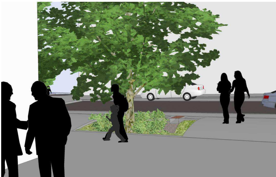
Figur 17 Lokalgata. Inloppen mynnar ytligt vid anlagt erosionsskydd. Gångbana avrinner mot växtbädden.
