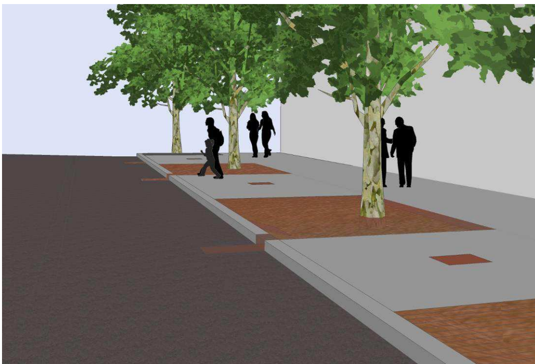
Figur 25 Erik Dahlbergsgatan. Inloppsbrunnar enligt samma princip som för lokalgatan. Luftbrunnar mellan trädgroparna kan föra ned dagvatten till emellanliggande kross.
