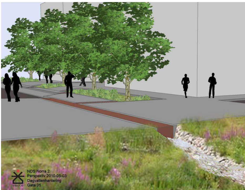
Figur 18 Lokalgata. Bräddränna som tar vatten ifrån lokalgatans växtbädd. Rännan mynnar i fuktstråk i park vid Husarviken. Alternativet till bräddränna är brunnar och tät bräddledning, vilket visas i planskiss.
