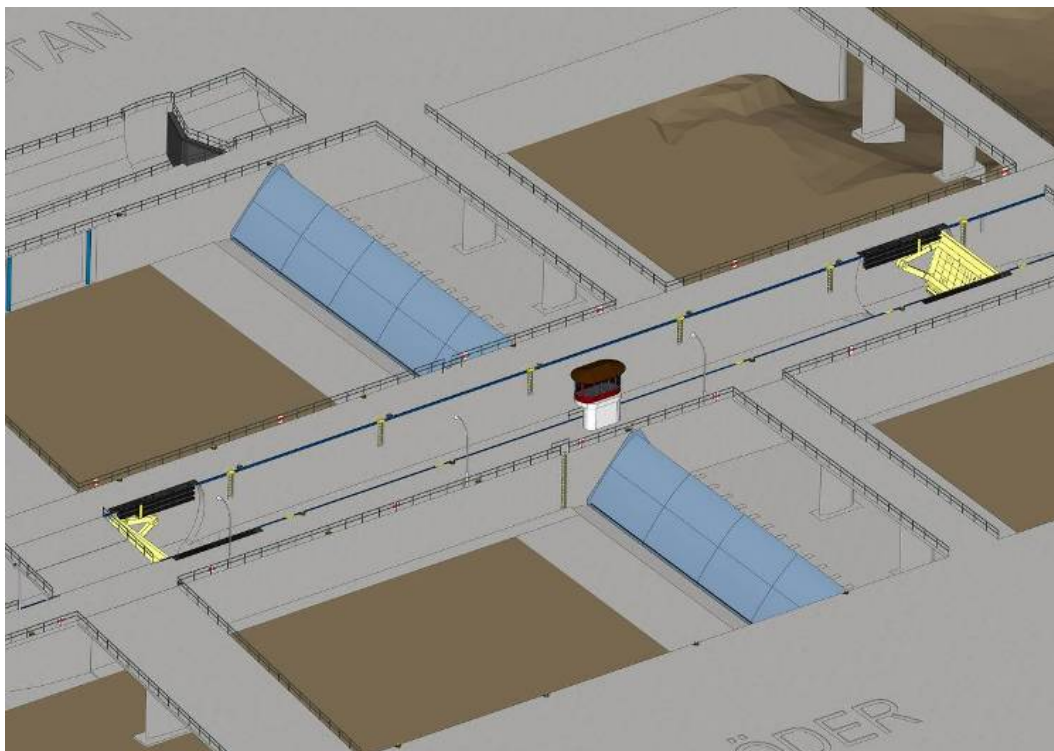
Figur 2.1.3. Principiell bild av slussluckor (gula) och luckor i avbördningskanalerna (blå) sedda från sydväst mot nordost
