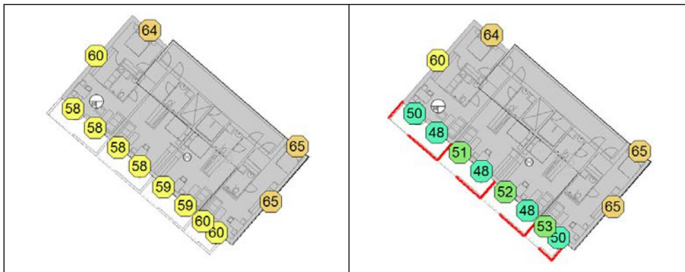
Figur 3. Ekvivalent ljudnivå (till vänster) och maximal ljudnivå från tågtrafik (till höger) vid uteplats (1,5 m över golv). Rött streck indikerar en tät skärm som är 2,5 m hög.
