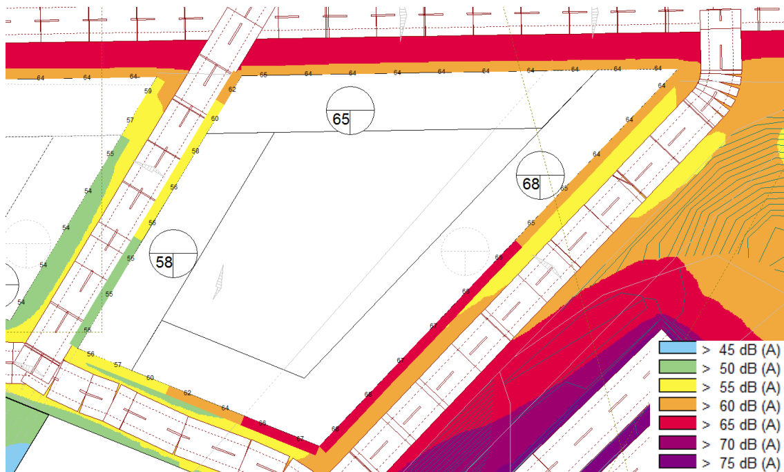
Figur 9. Beräkningsresultat, cirklar med numeriskt värde visar högsta frifältskorrigerad dygnsekvivalent ljudnivå vid fasad dB(A). Färgkartan visar dygnsekvivalent ljudnivå på höjden 1,5 [meter]. I stort sett överskrider 55 dB(A) vid samtliga fasader för hus A1. Med genomtänkt planlösning d.v.s. med luddämpad sida och med rätt val av fasadisolering mot bullrande sida kan en god boendemiljö uppnås. För att få till luddämpad sida mot innergård krävs i regel större lägenheter i bullerutsatta hörnlägen.
