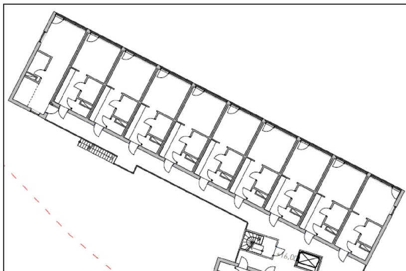
Figur 6. Planlösning hus B. Typplan för plan 2-4.
