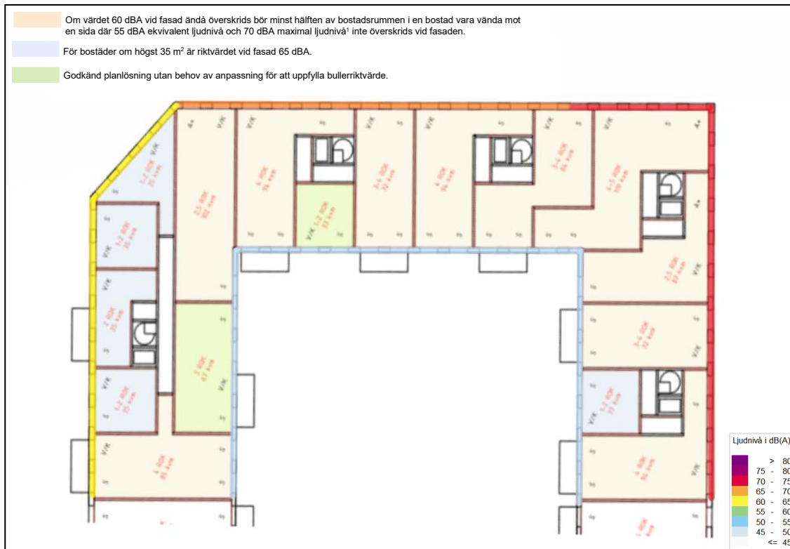
Figur 11. Typplan för plan 1 i Etapp 1, Kvarter B. Färgmarkering avser den högsta beräknade ekvivalenta ljudnivån vid fasad.
