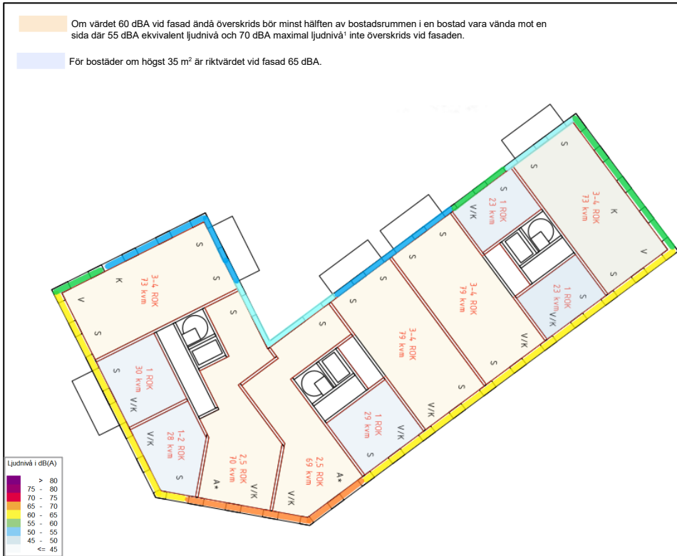
Figur 8. Typplan för plan 5, Kvarter A2. Färgmarkering avser den högsta beräknade ekvivalenta ljudnivån vid fasad.
