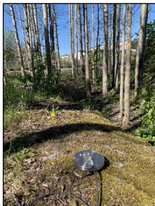
Bild 1 visar vibrationsgivare på berg i mätpunkt 1
