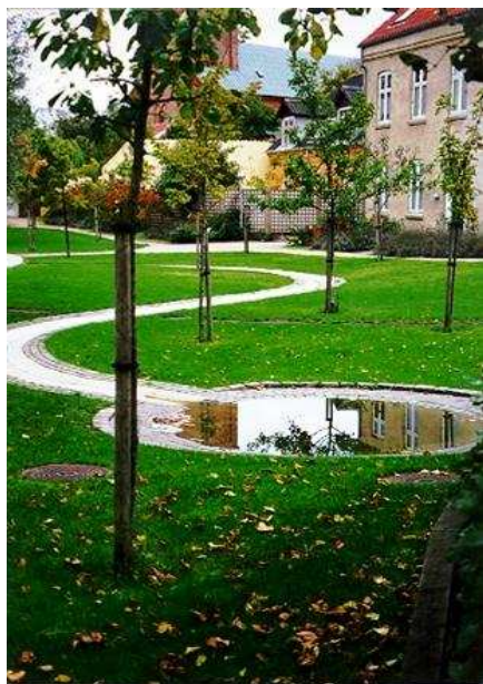
Figur 7. Exempel på utformning av små fördröjningsdammar och översvämningsytor.
