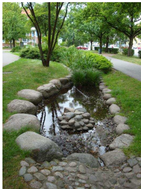
Figur 7. Exempel på utformning av små fördröjningsdammar och översvämningsytor.
