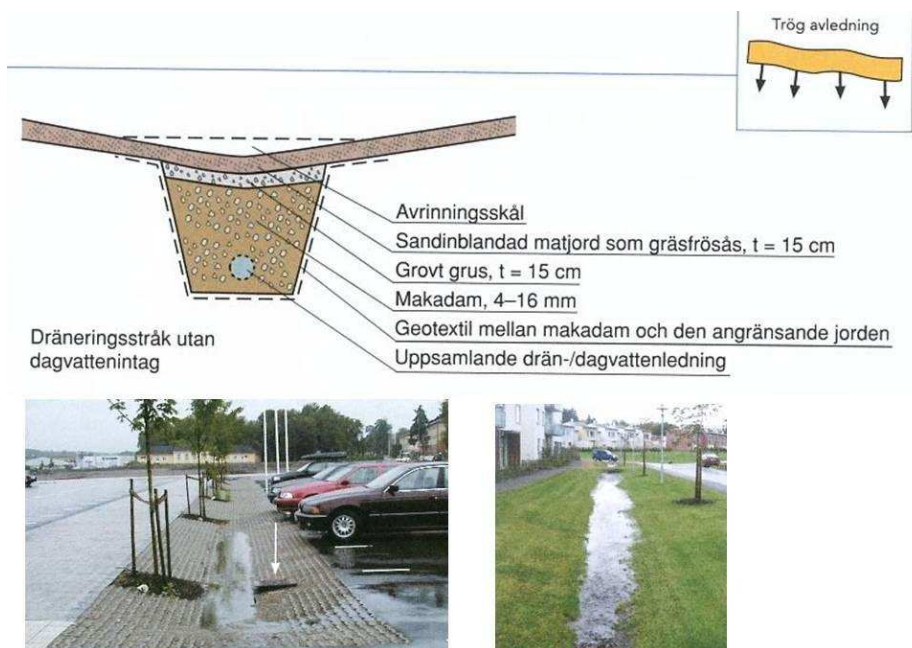
Figur 4. Principuppbyggnad av ett avrinningsstråk med rasterplattor (t.v.) och gräs (t.h.). Bilder från P105.
