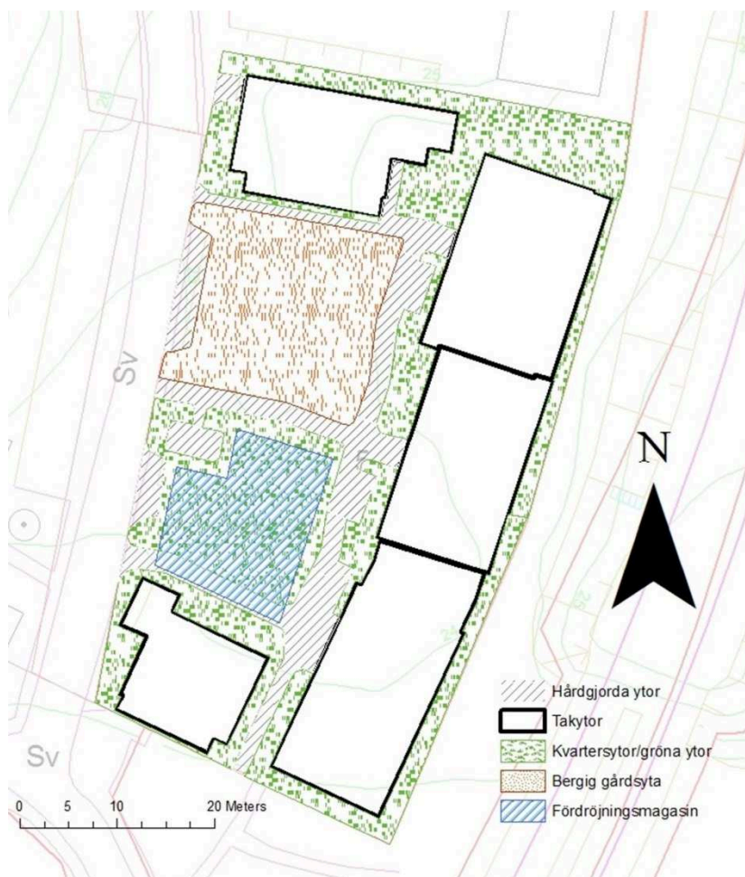
Födröjningsmagasinet inom Gamlebo 5 placeras under den södra gårdsdelen (inom det blåskrafferade området).
