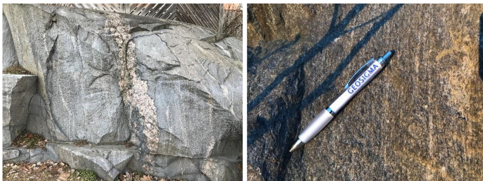
Figur 2-3 Sedimentådergnejs med tydlig foliation och inslag av pegmatitgångar.
