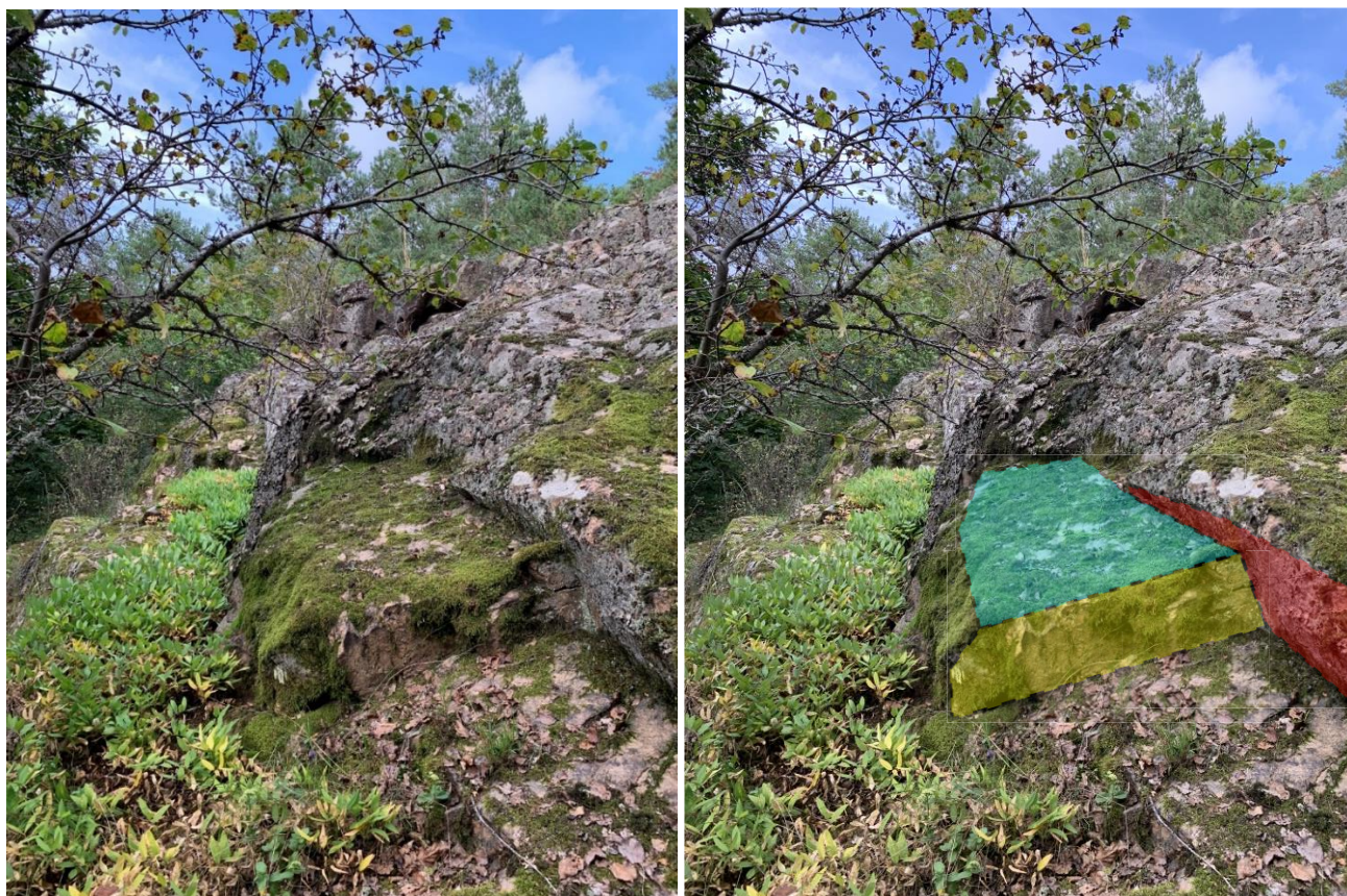
Figur 5: Tydliga sprickgrupper i berget. Bankingsplan (i blå färg) skiftar runt 5-30 grader i lutning.
