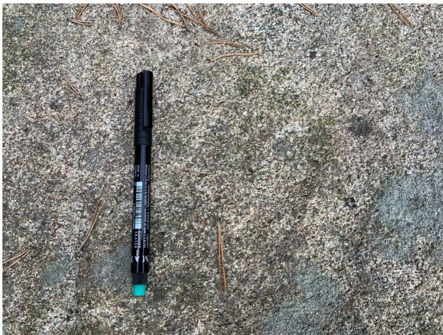
Figur 12: Mellankornig gnejsgranit/grågranit, grå kvarts och vit fältspat kristaller.
