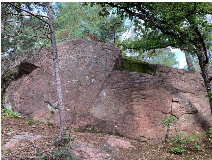
Figur 8: Massiv röd omvandlad gnejsgranit med få, plana till vågformiga, långa sprickor.
