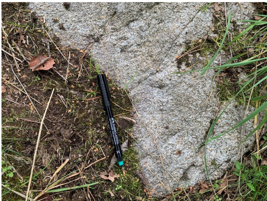
Figur 29: Vit mellan-grovkornig gnejsgranit.
