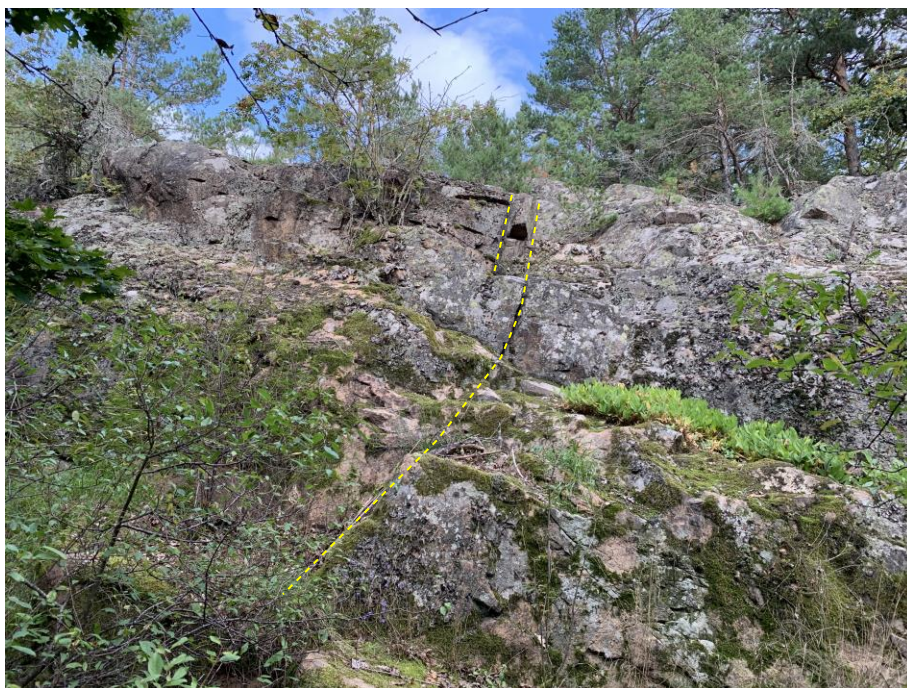
Figur 4: Branta sprickor i gnejsgranit som tillhör en sprickgrupp.
