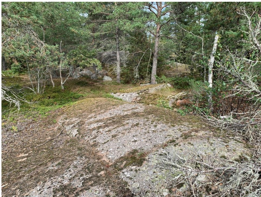
Figur 13: Massiv gnejsgranit i dagen med få sprickor.
