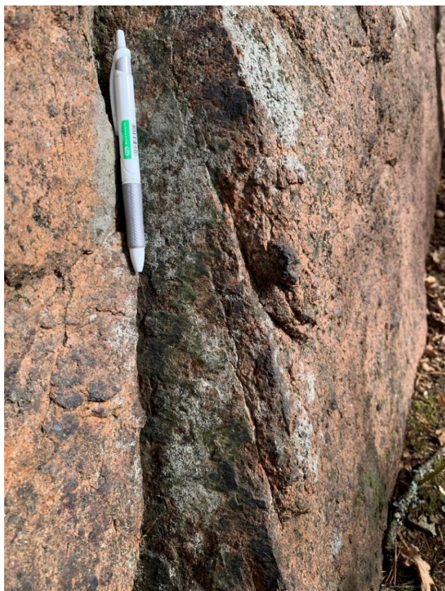
Figur 9: Omvandlad epidot eller klorit på en spricka.
