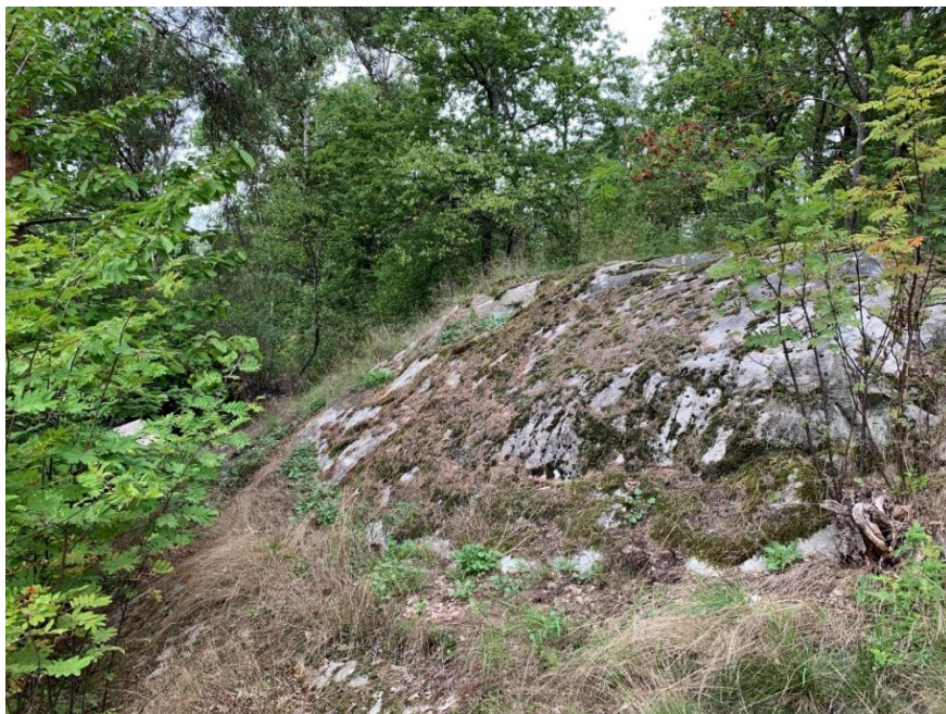
Figur 43: Berg i dagen som anvisades som sedimentär gnejs/gnejsgranit.
