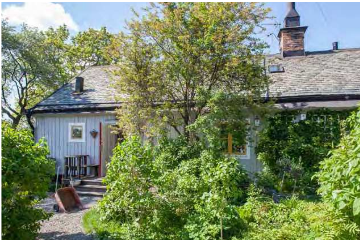
Mangelbodsvillan från öster. Den största utvändiga förändringen är upptagandet av nya fönsteröppningar under 1980-talet. Samtidigt byttes samtliga ytterdörrar med tillhörande trappor. ME SSM_10002136S
