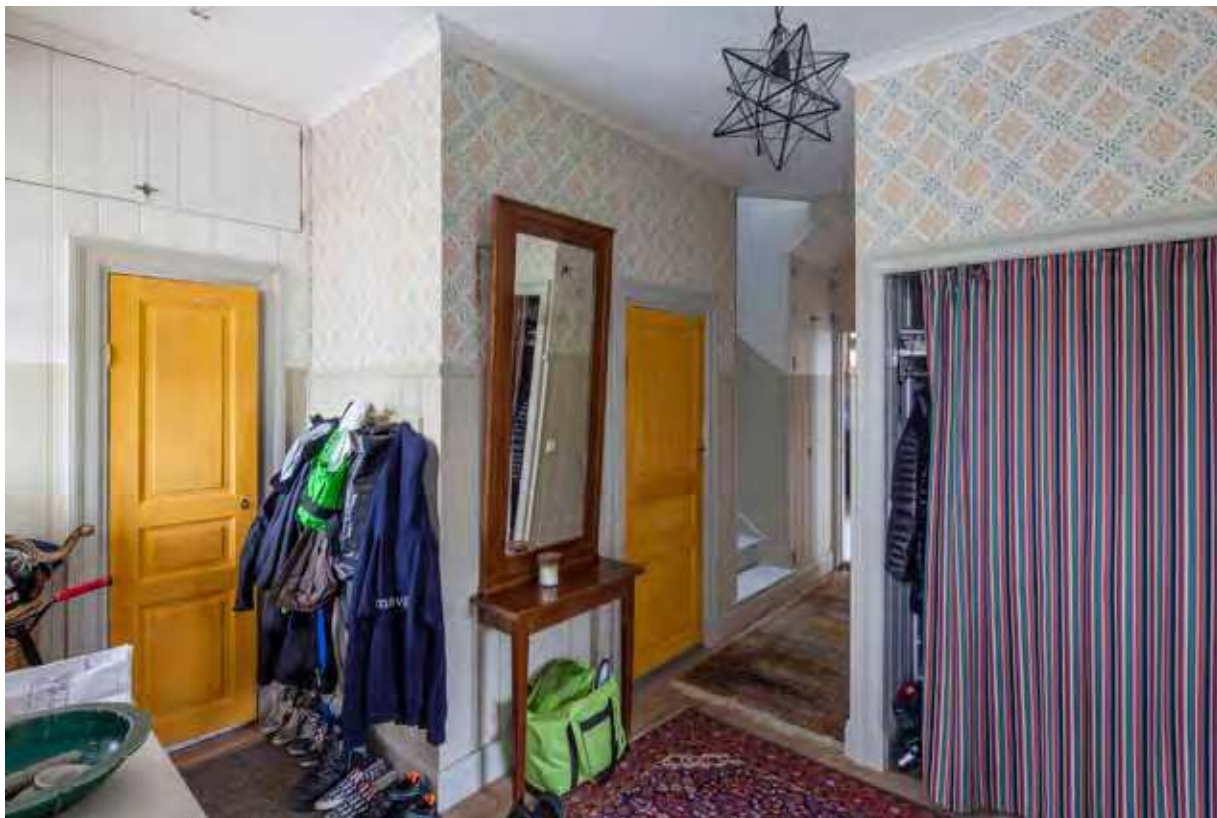
Rum 240 mot söder. Rummets dörr- och fönsterfoder är nytillverkade efter äldre profil. ME SSM_10001994S
