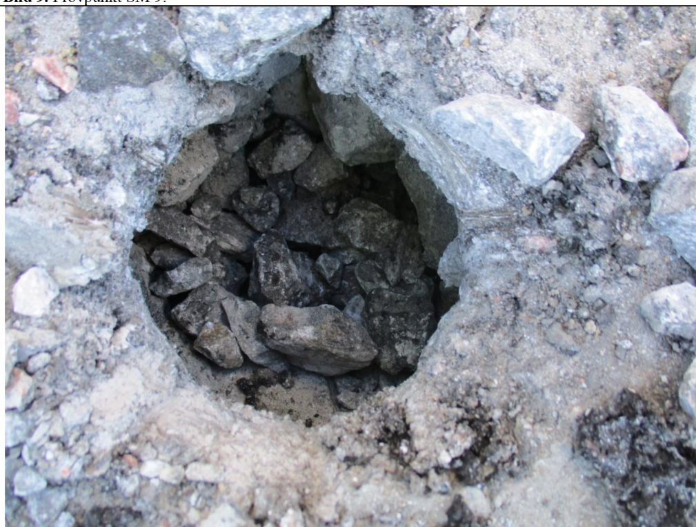
Bild 10. Provpunkt SM 9, borrhål med stenfyllning under asfalt.
