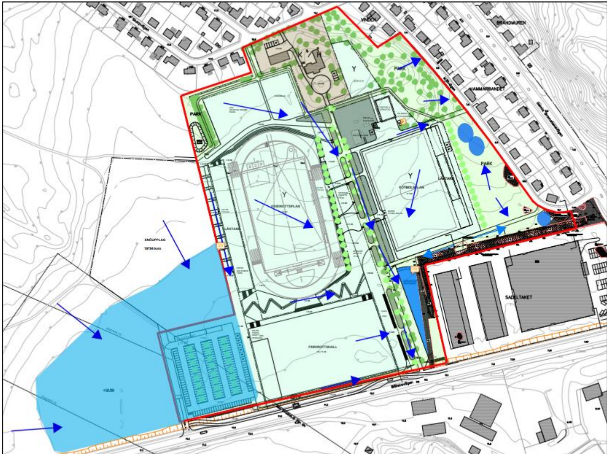
Figur 15. Översvämningsytor vid skyfall har illustrerats med mellanblå yta inom området och med ljusblå yta utanför planområdet inklusive parkeringsytan. Ytlig avrinning av dagvatten är redovisad med mörkblå pilar, dikesanvisningar med mellanblå pilar
