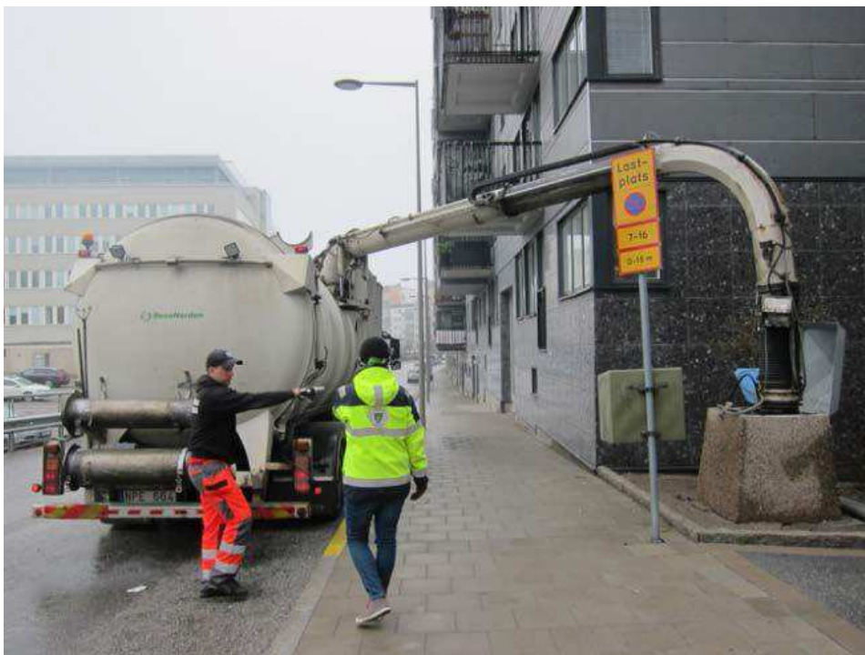
Bild 02 Tömning med mobil sopsugsbil. Källa: Stockholm Vatten
