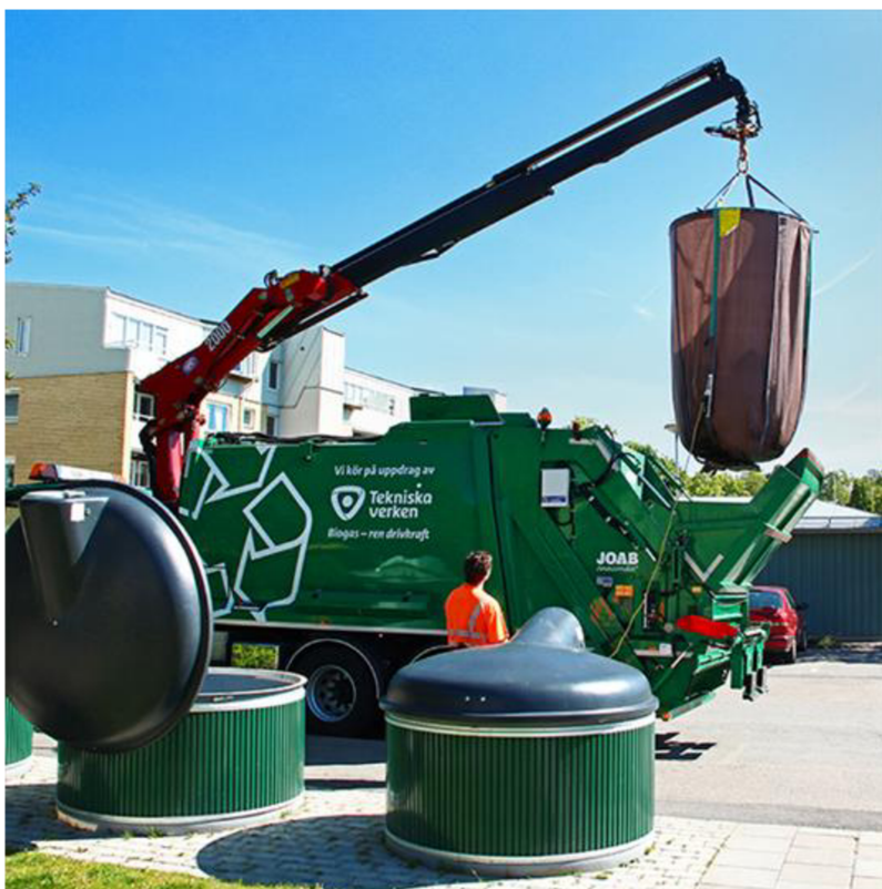
Bild 05 Tömning av krantömd behållare
