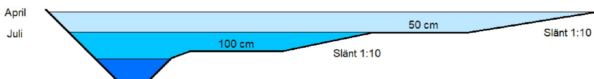
Figur 8. Enkel schematisk skiss över den nya dammen i profil. Cm-angivelserna är bottenens djup under vattnet. Observera att mittennivån har ett vattendjup på 100 cm i april och 50 cm i juli.
