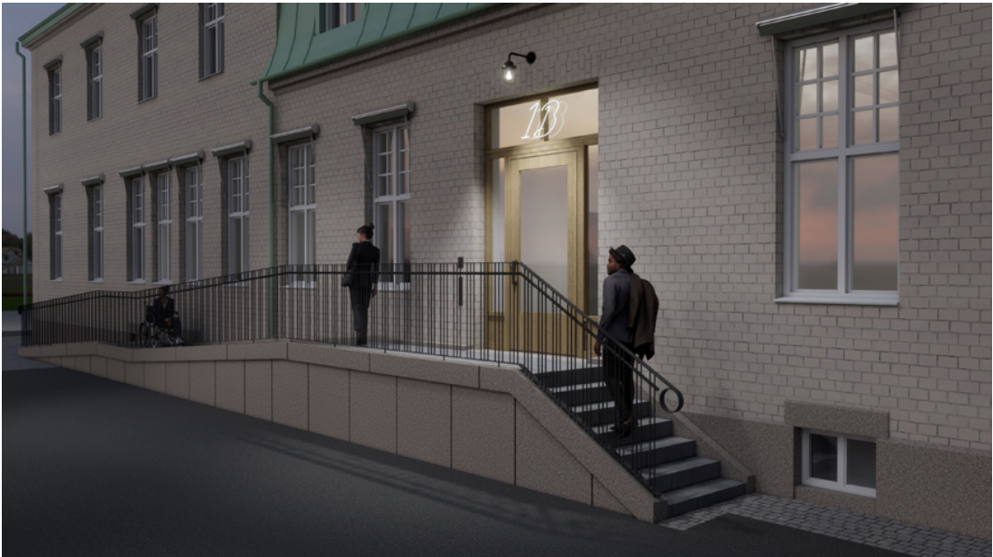
Dörrparti i trä, trappa och ramp klädda i material med nära släktskap med befintlig sockel. Belysning i samklang med befintlig arkitektur.
