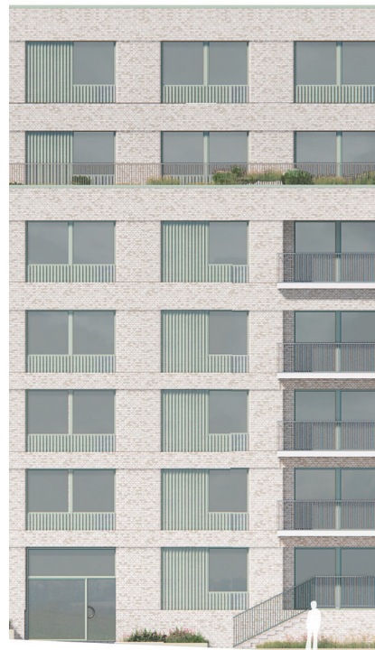
Fasadvariant med utstickande balkong och fyllningar i sinuskorrugerad fiberbetong. (Boskapsvägen) Illustration: Arkitema
