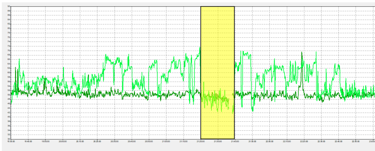
Figur 12. Ljudnivå under konsert, mätpunkt på parkeringsdäck. Mörkgrön: ljudnivå i dBA (ca 50-52 dBA). Ljusgrön: ovägd ljudtrycksnivå i tersbandet 50 Hz (varierande upp till 72 dB). Frifältsvärden. Skala på Y-axeln 30–90 dBA.
