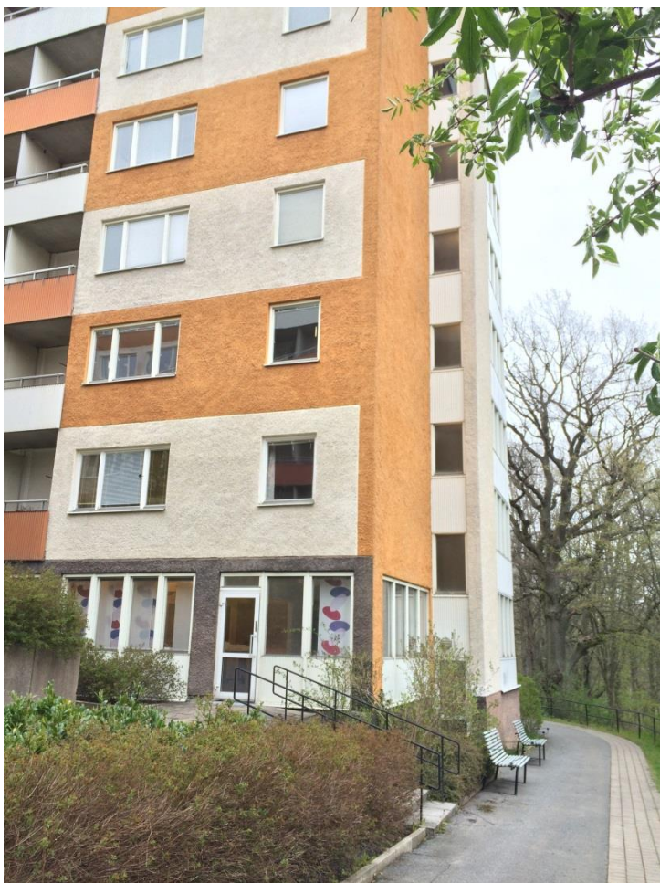
Hus B, dess gavel mot Magelungens strand och en del av planteringen mellan huskropparna. Husen ligger delvis i souterrain, och då markeras "sockelvåningen" med varmgrå spritputs. Foto: förf.
