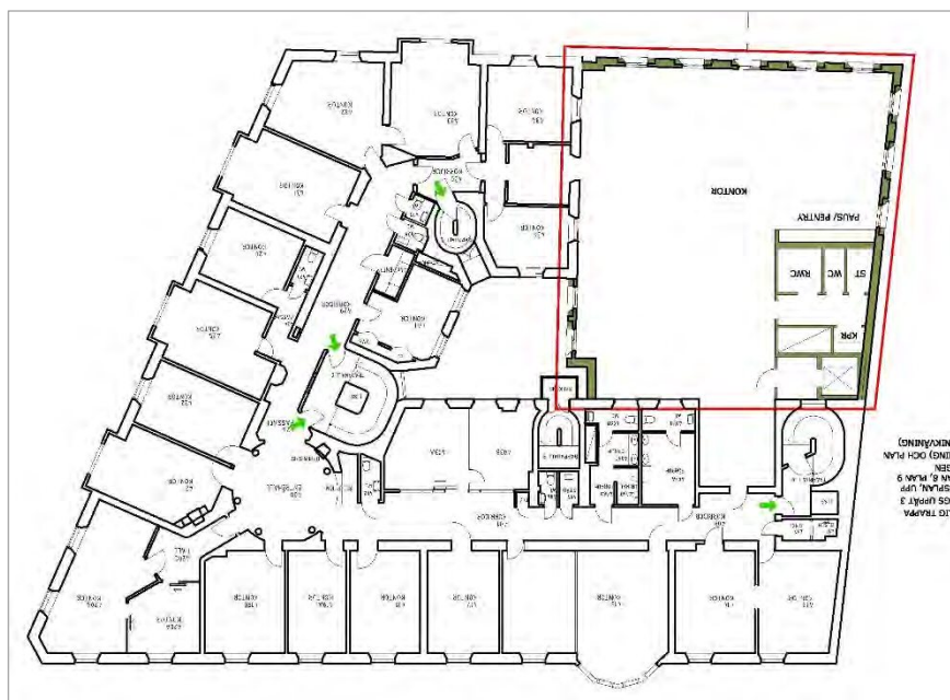
Tillbyggnadsförslagets normalplan som redovisar hur man har för avsikt att koppla samman den nya byggnaden med den befintliga. Källa: AIX förslagsritning.
