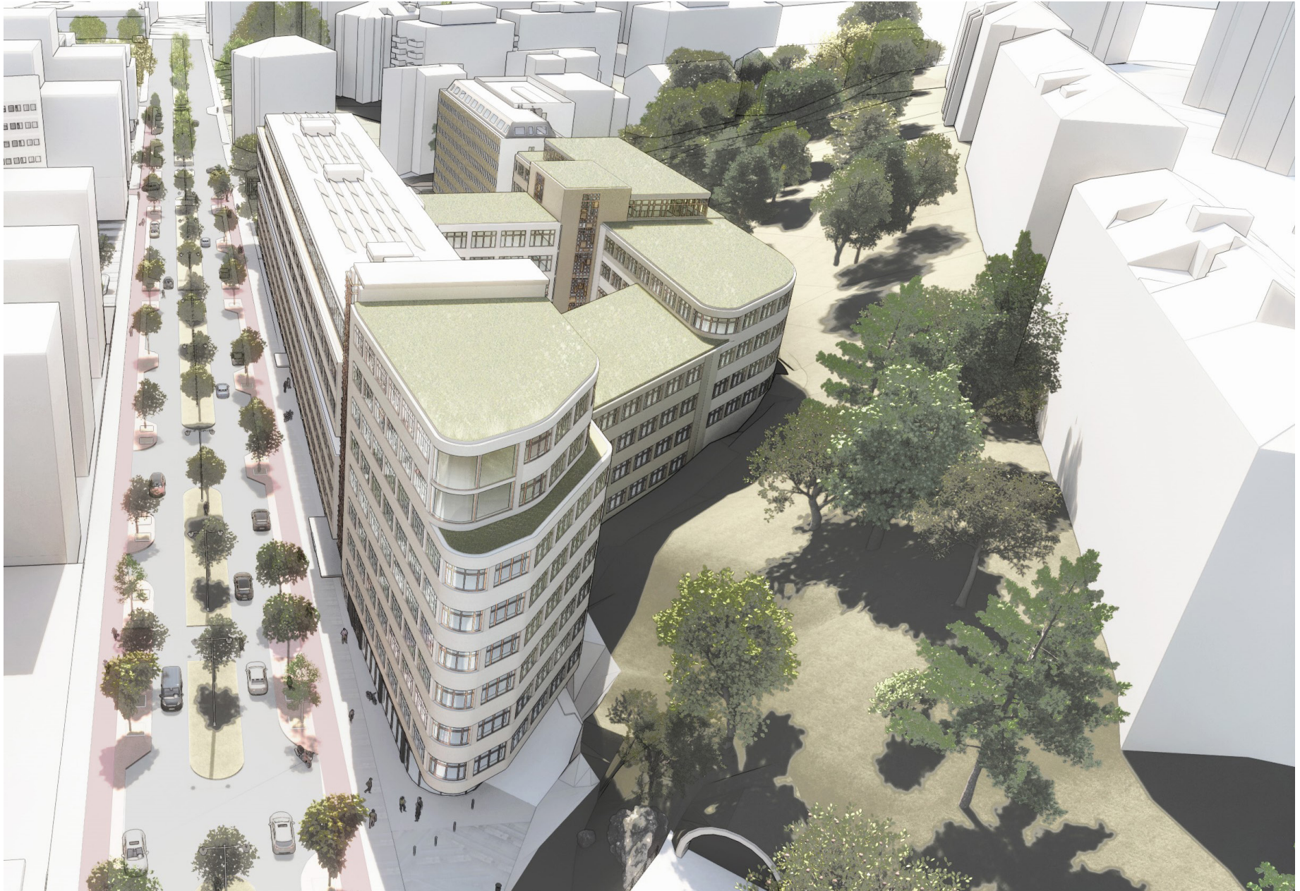
Illustration som visar omfattningen av nya byggnadsvolymer. KM-huset kopplas samman med nya byggnader i sluttningen på två ställen och vid dess gavel i nordväst placeras ett nytt högt trapphus. Illustration: Wester + Elsner
