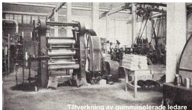
Tillverkning av gummiisolerade ledare
