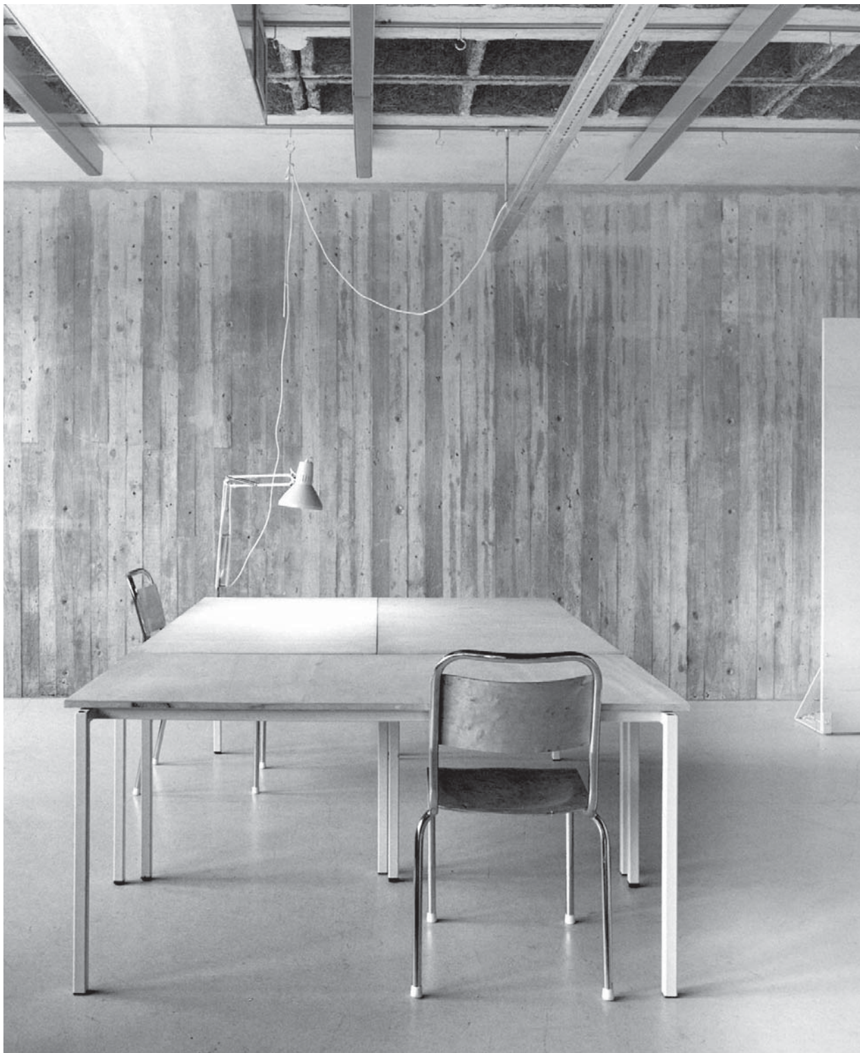
Ritsalarna var möblerade med stolar tillverkade av en firma i Sundbyberg och med specialritade ritbord som kunde staplas och ställas ihop till större bord. I taket syns ljudabsorbenter av träullscement och det flexibla systemet med lysrör, kabelskenor och "pendel" för upphängning av lampsladdar. Foto: Sten Vilson 1970. (Informant 1.)
