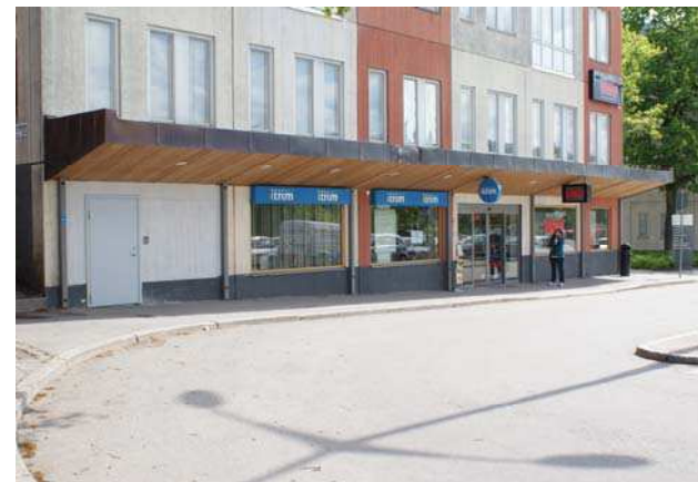
En bingolokal har inretts i ett f.d. garage vid Karlandaplan i Väst. Fönstren är förstorade och ett skärmtak har satts upp.
