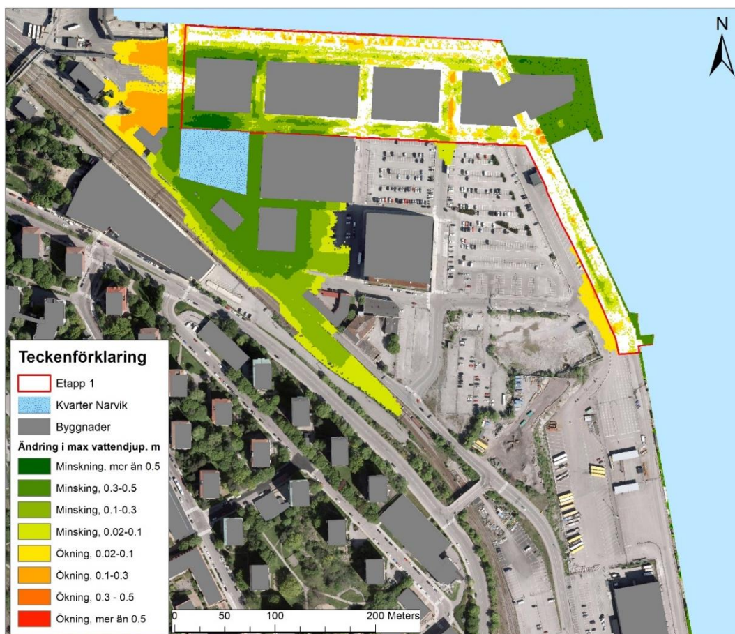
Figur 17: Jämförelse av maximala vattendjup vid ett skyfall efter utbyggnad av norra delen med åtgärdsförslag 1 (sänkning av kv. Narvik) mot dagsläget. Bilden beskriver påverkan som norra delen beräknas ha på översvämningssituationen.
