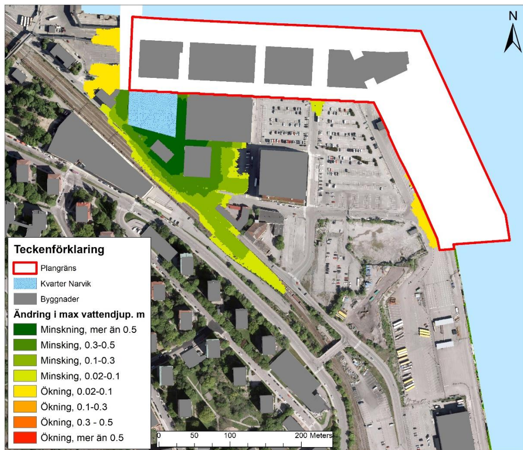
Figur 21: Jämförelse av maximala vattendjup vid ett skyfall efter utbyggnad av norra delen med Åtgärdsförslag 2 (sänkning av kv. Narvik samt avvattningsledning mot dagsläget). Bilden beskriver påverkan som norra delen beräknas ha på översvämningssituationen.
