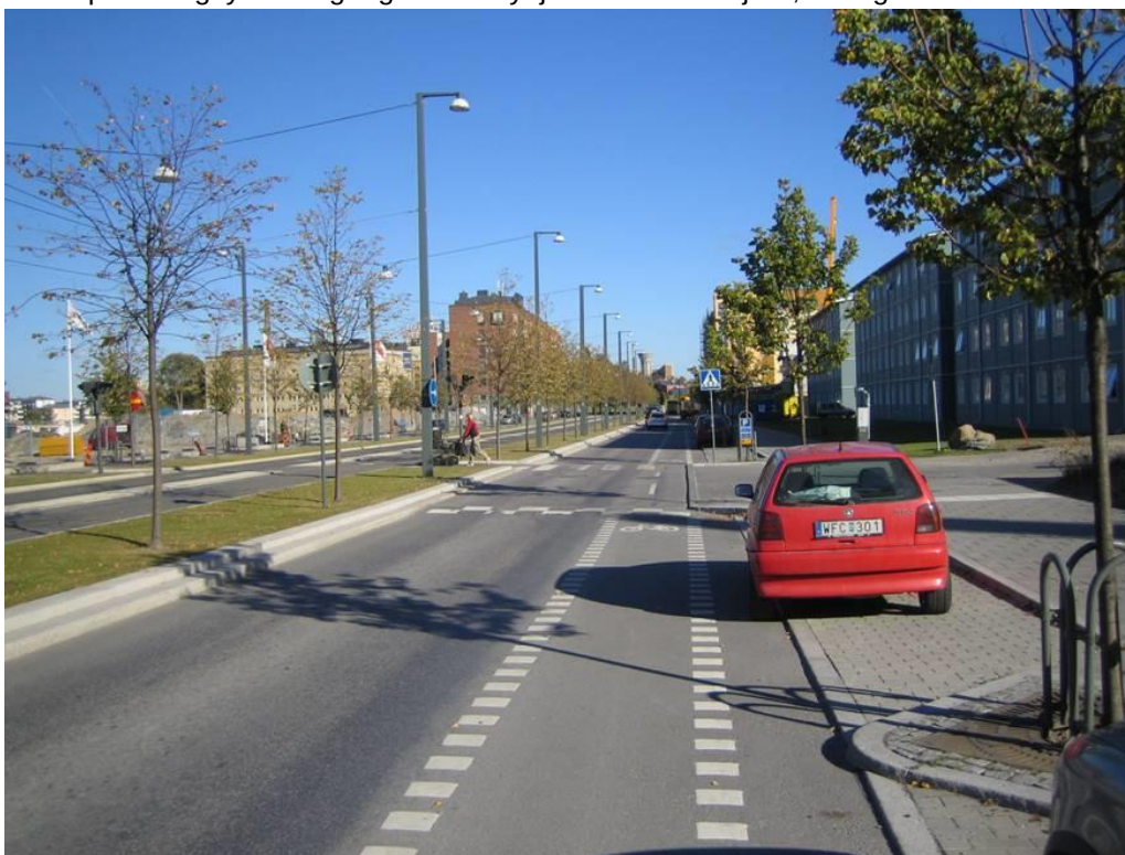
Figur 22 Figuren visar att träden till höger, som växer i skelettjord och får dagvatten, fortfarande har gröna blad jämfört med de träd som växer till vänster där det inte är skelettjord.
