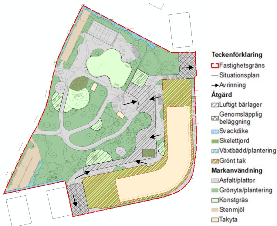
Figur 16. Asfalterade/plattsatta ytor samt konstgräsytor leds till genomsläpplig beläggning och luftiga bärlager. Pilar visar avledning.
