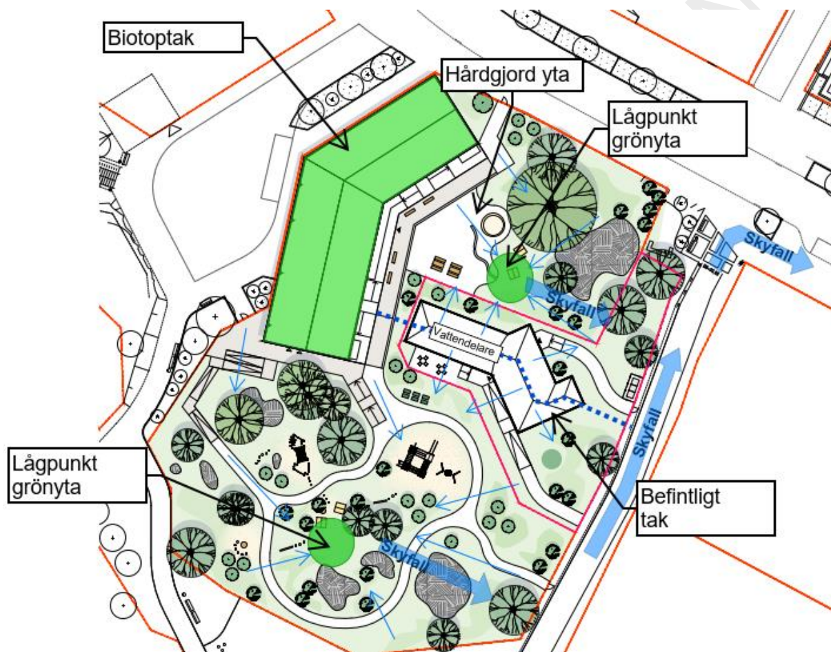
Figur 3. Förskolan Villan. Systemlösning dagvattenhantering. Föreslagna lågpunkter redovisas som gröna cirklar. Den lokala vattendelaren redovisas, varifrån avrinning bedöms ske norr- respektive söderut. Flödesriktning för dagvatten illustreras med tunna blå pilar och flödesvägar vid skyfall illustreras med stora pilar.
