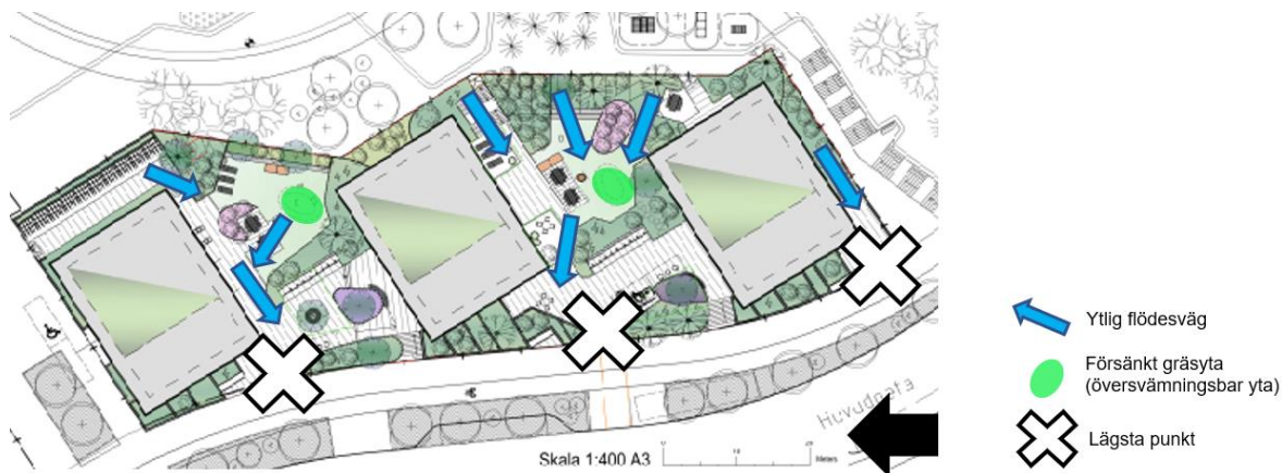
Figur 30. Blå pilar markerar ytliga flödesvägar, de gröna ytorna markerar försänkta gräsytor där vatten kan bli stående. Vita kryss markerar lågpunkter i tomtgräns på kvartersmark. (LandArk, 2021).
