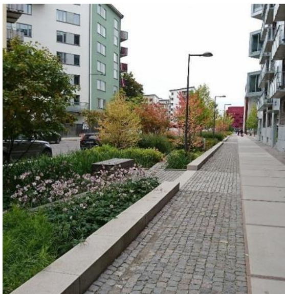
Figur 20. Dagvattenhantering på bjälklag, principuppbyggnad av växtlighet på bjälklag samt exempel med nedsänkta växtbäddar.
