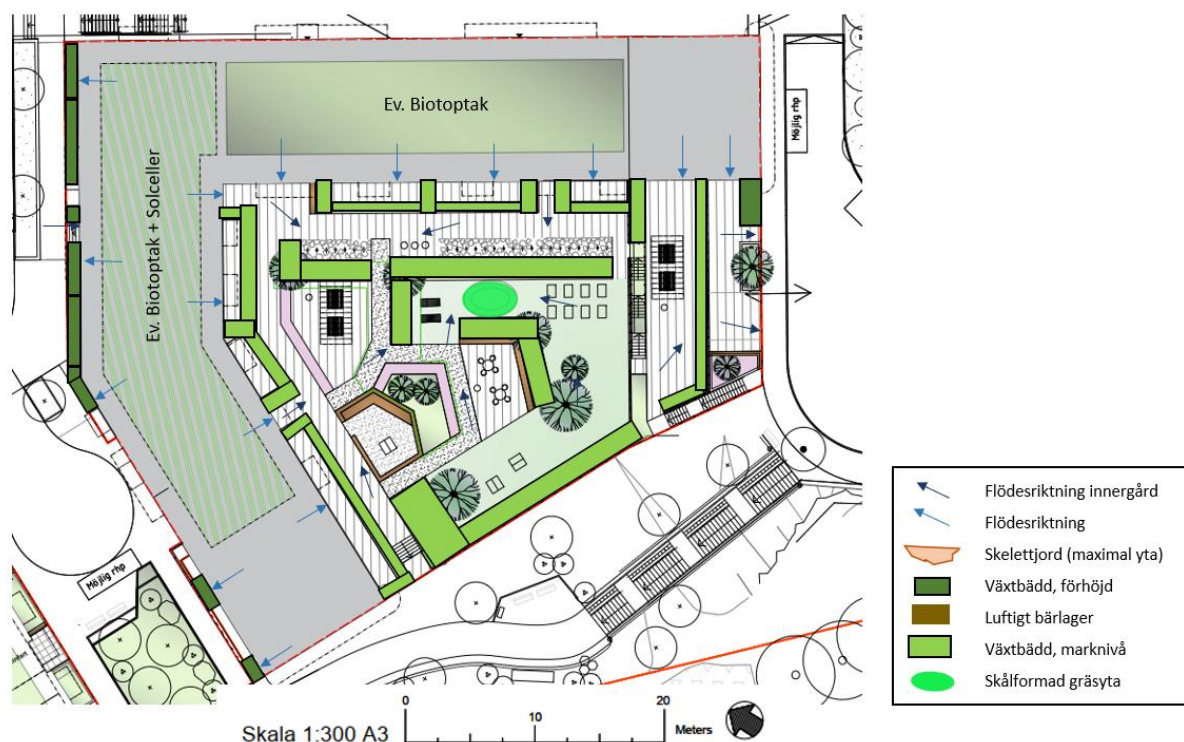
Figur 24. Förslag på dagvattenåtgärder för kvarter E (LandArk, 2023).
