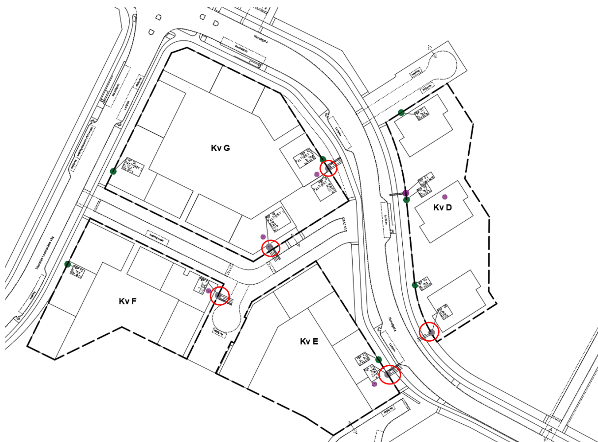
Figur 15. Befintligt och eventuellt framtida ledningsnät. Röda ringar visar önskade lägen för anslutningspunkter till respektive fastighet, men som ännu ej bekräftats av SVOA.
