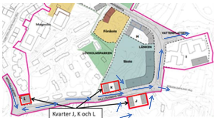
Figur 14 Blå pilar visar övergripande skyfallsvägar i närheten av kvarteren J, K och L.
