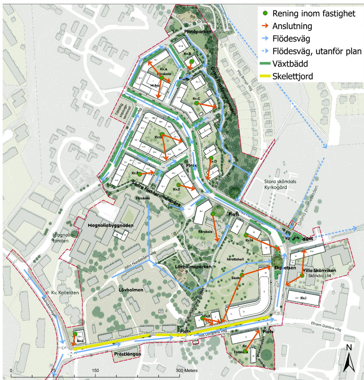
Figur 45 Översikt över flöden och hantering av dagvatten inom Etapp 2A. Redovisade dagvattenanslutningar avser önskemål från kvartersutredningar och utreds vidare vid detaljprojektering.
