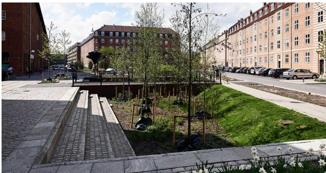
Figur 30. Exempel på ett torg med tydliga inslag av dagvattenhantering i nedsänkta grönytor, Tåsinge Plads i Köpenhamn.
