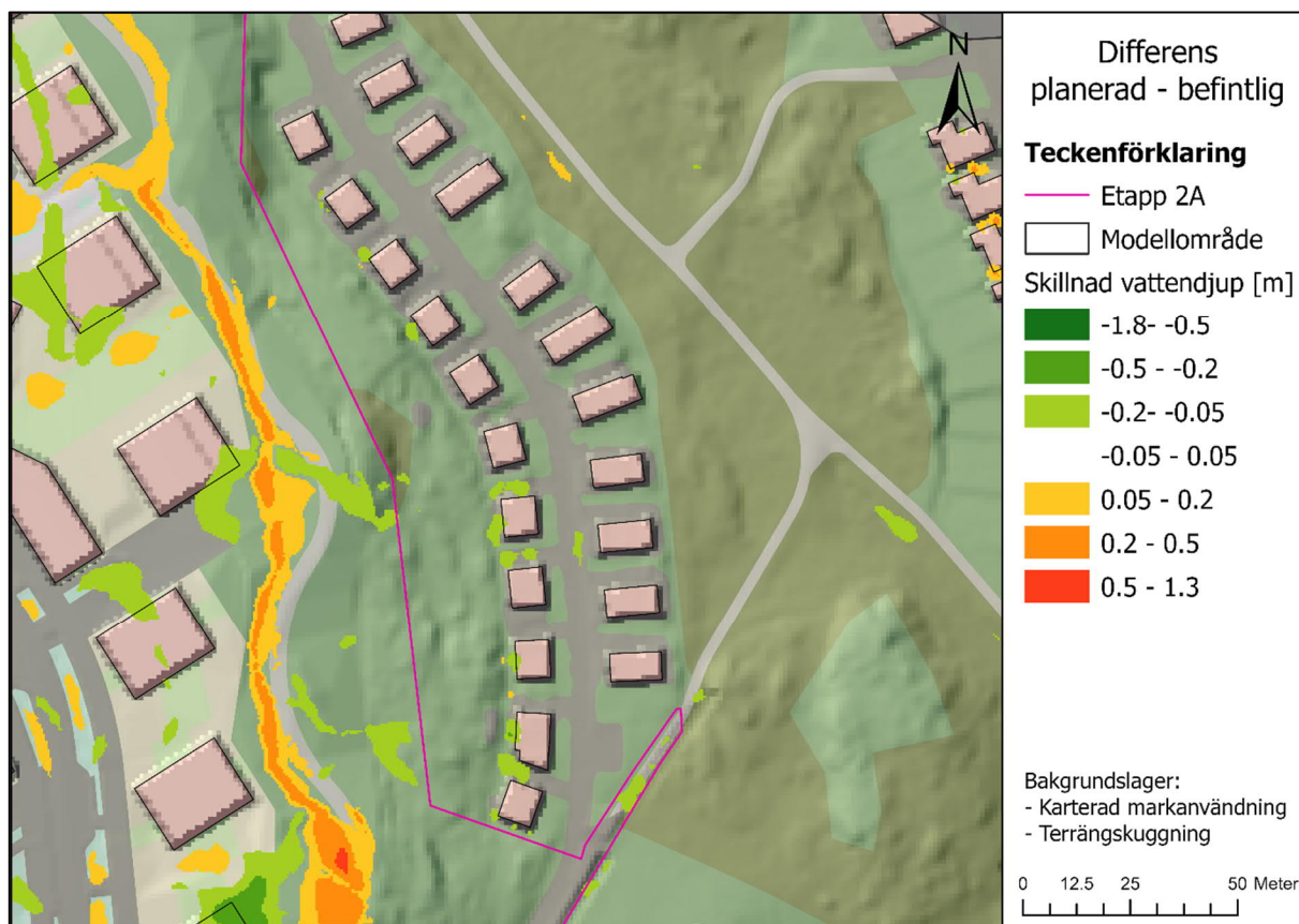
Figur 34. Skillnad mellan maximal vattennivå vid befintlig och planerad situation längs Platåpromenaden. Grön färg indikerar mindre vatten och rödorange indikerar mer.
