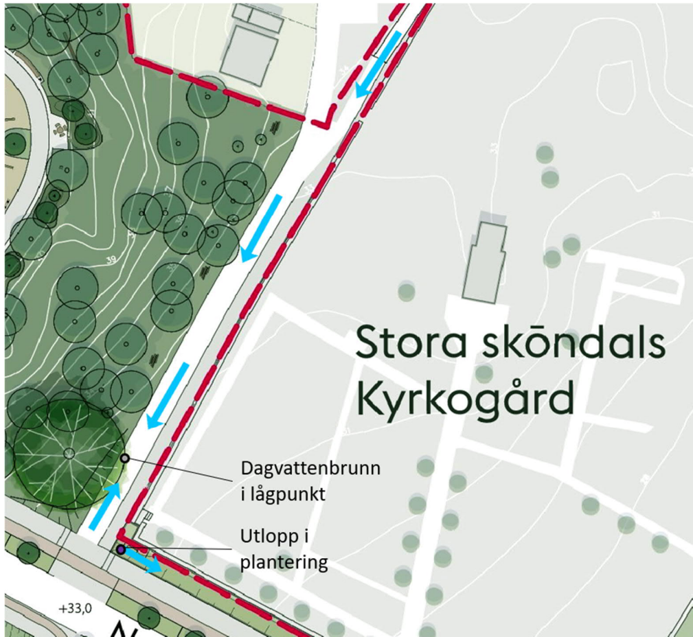
Figur 26. Föreslagen dagvattenhantering på Wilhelm Lindboms väg. Blå pilar indikerar dagvattnets planerade flödesriktning.
