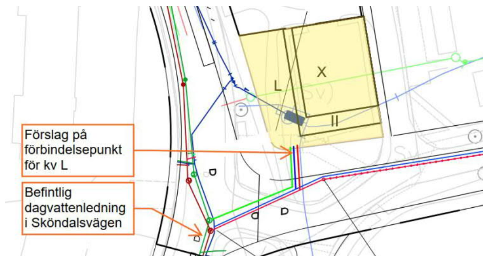
Figur 32. Befintliga ledningar och föreslagen förbindelsepunkt för kvarter L.
