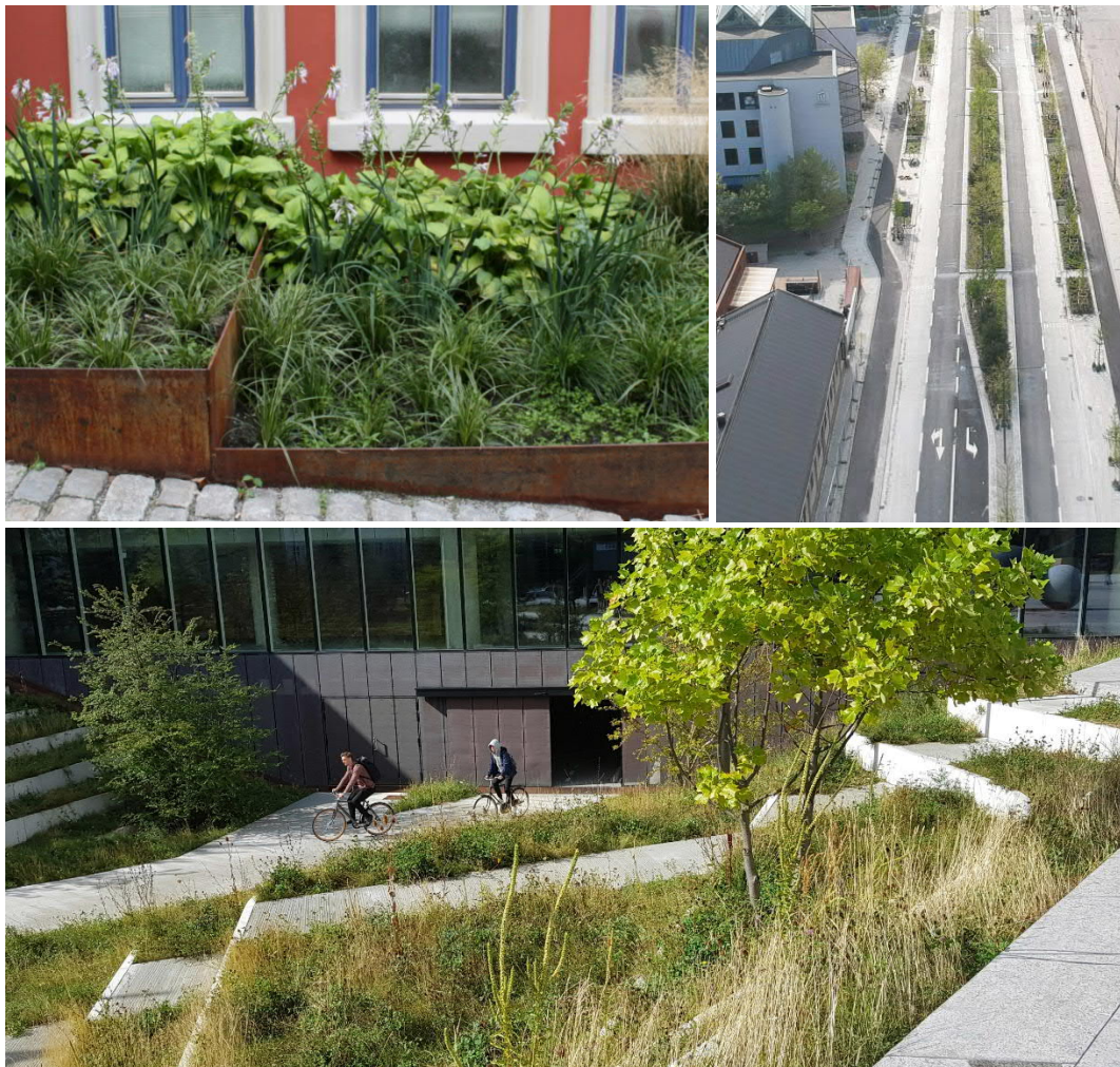
Figur 21. Vänster: Exempel på öppna terrasserade växtbäddar i Oslo. Höger: Exempel på huvudgata med stort inslag av grönutrymmen för dagvattenhantering, Neptunigatan i Malmö. Foto: Niklas Petersson. Båda från "Levande gaturum – en handbok i blågröngrå system". Under: Exempel på terrasserad dagvattenhantering i Köpenhamn, foto: Joakim Scharp
