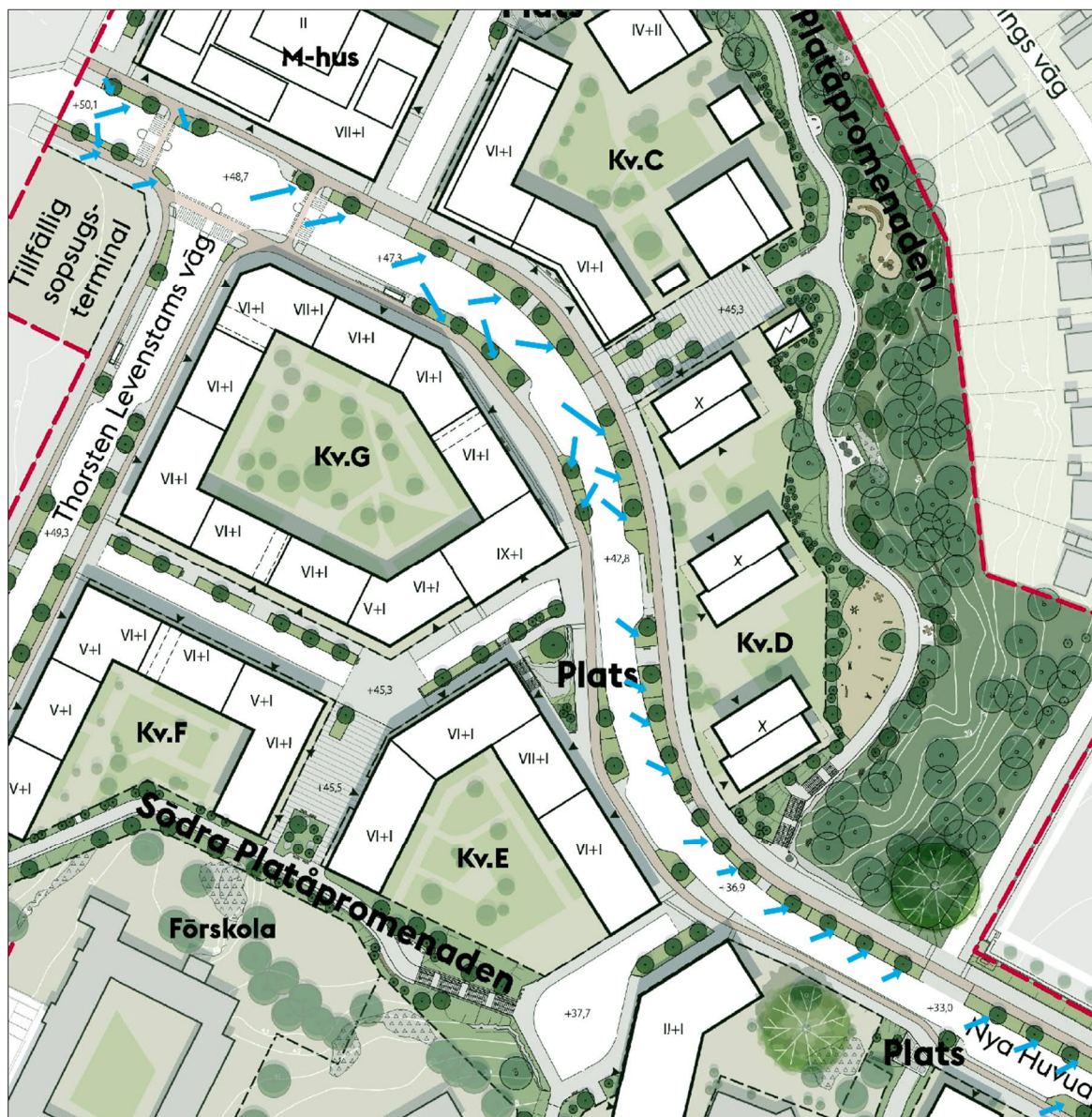
Figur 22. Föreslagen dagvattenhantering längs nya huvudgatan. Blå pilar indikerar dagvattnets planerade flödesriktning.
