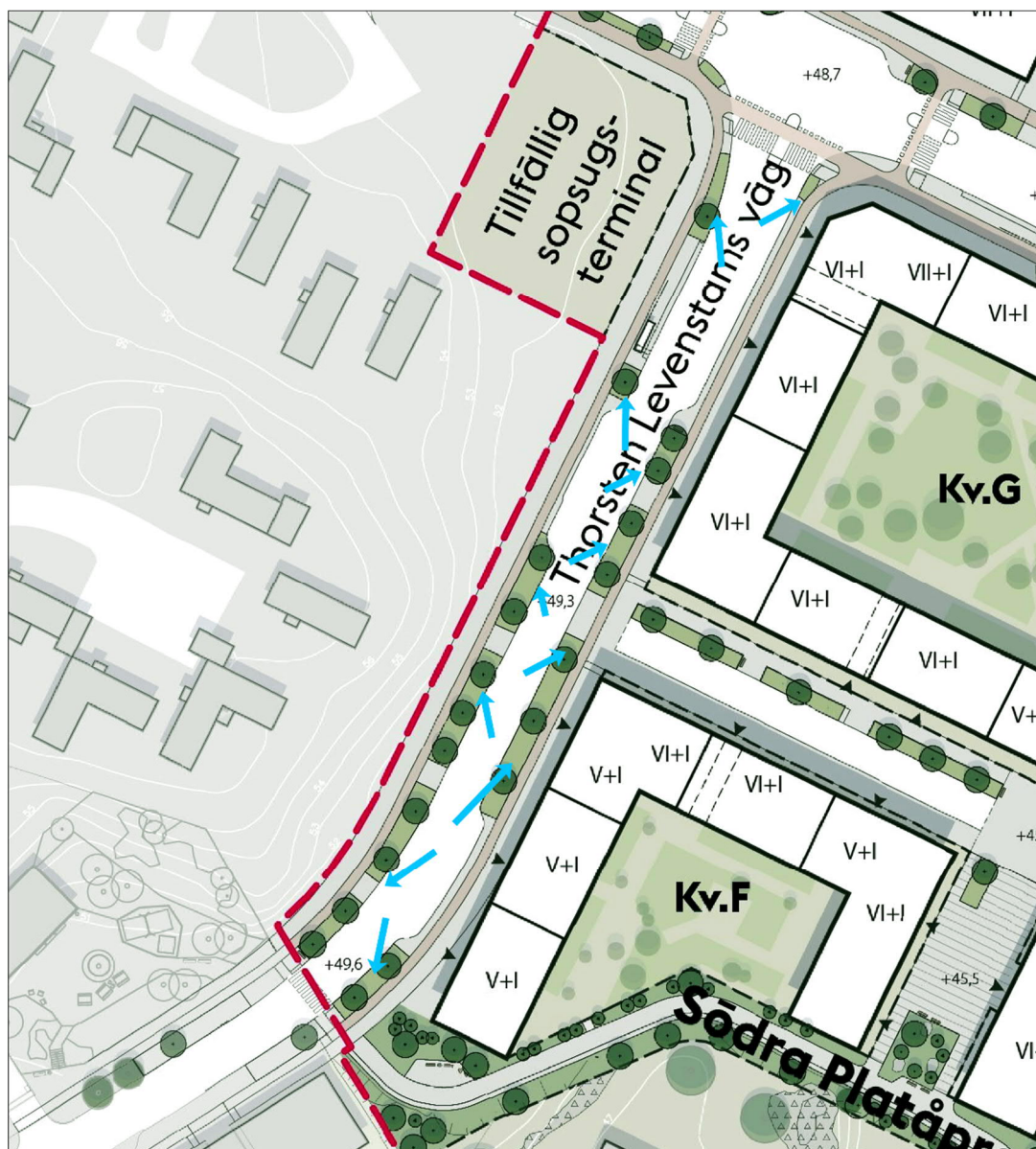
Figur 25. Föreslagen dagvattenhantering längs Thorsten Levenstams väg. Blå pilar indikerar dagvattnets planerade flödesriktning.
