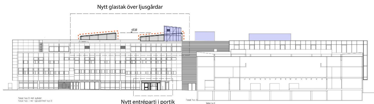
Bilden visar nytt glastak/ lanterniner (inom röstreckad linje) i relation till de befintliga fläktrum (blå ytor) som finns idag. Bild: Gatun, bearbetning SBK.
