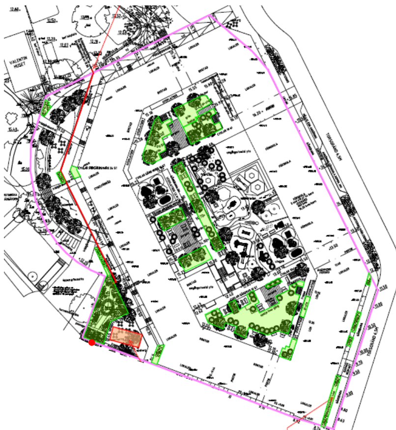
Figuren illustrerar principförslag för omhändertagande av dagvatten. Gröna ytor avser ytor med växtlighet för rening av dagvatten. Orange yta visar på möjligt perkolationsmagasin med makadam. Röd linje markerar läge för ränna som ska säkra flödesväg för skyfall över fastigheten. Röd punkt markerar förbindelsepunkt till stadens ledningsnät. Källa: Bengt Dahlgren Stockholm AB
