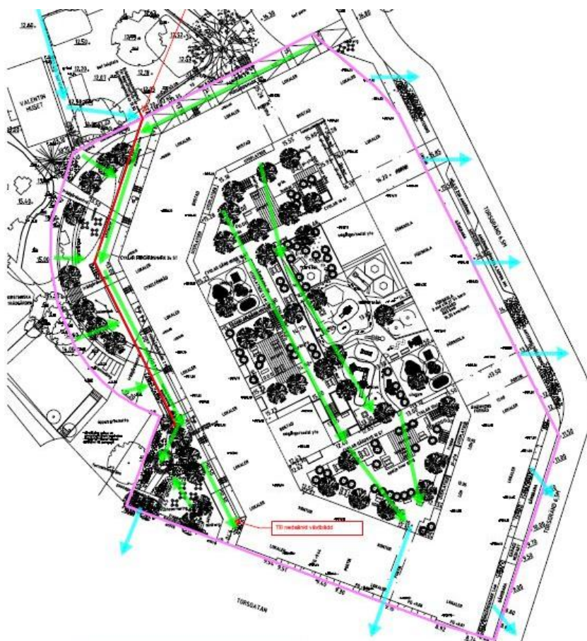
Illustration över flödesriktningar för dagvatten. Blåa pilar visar avrinning av dagvatten vid skyfall. Den röda linjen visar läge för betongkanalen som ska säkra flödesvägen för skyfall över fastigheten. Källa: Bengt Dahlgren Stockholm AB
