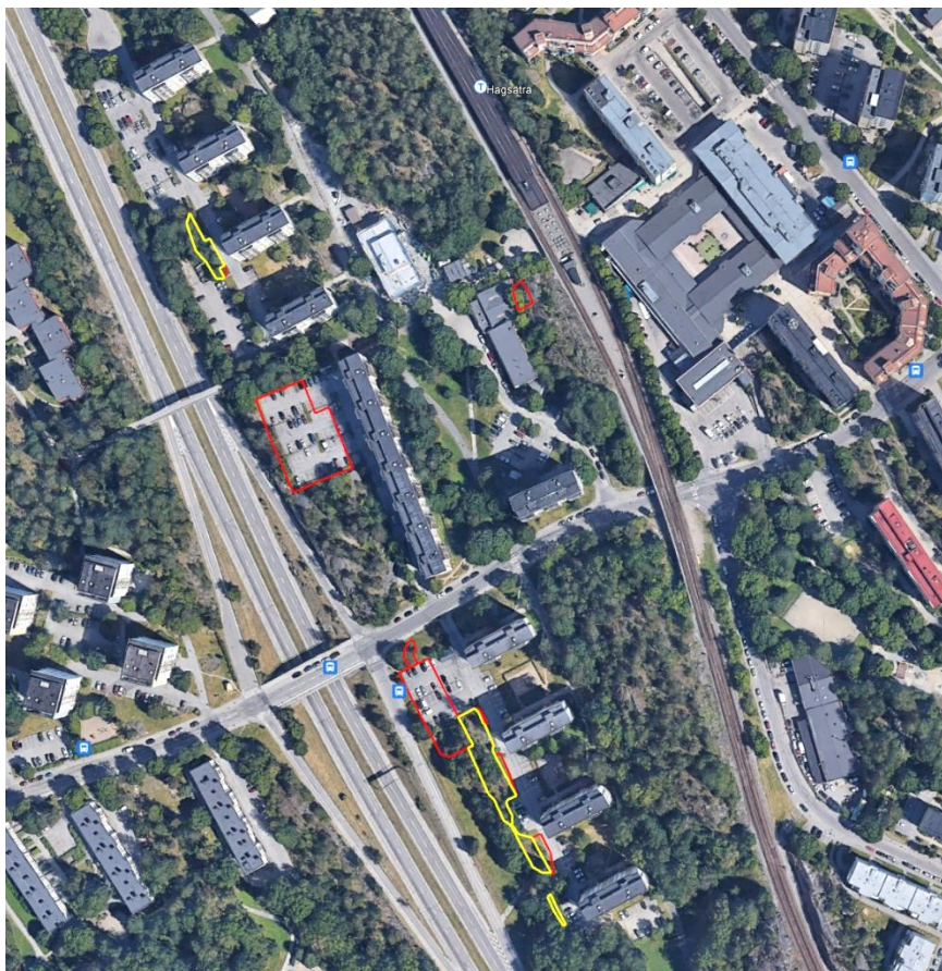
Figur 14. Översikt av områden med bergschakt. Inom röda områden kommer bergschakt för byggnad bli aktuell. Inom gula områden bedöms bergschakt krävas för planerade gator. Ytterligare bergschakt kan även krävas för planerade va-ledningar m.m.
