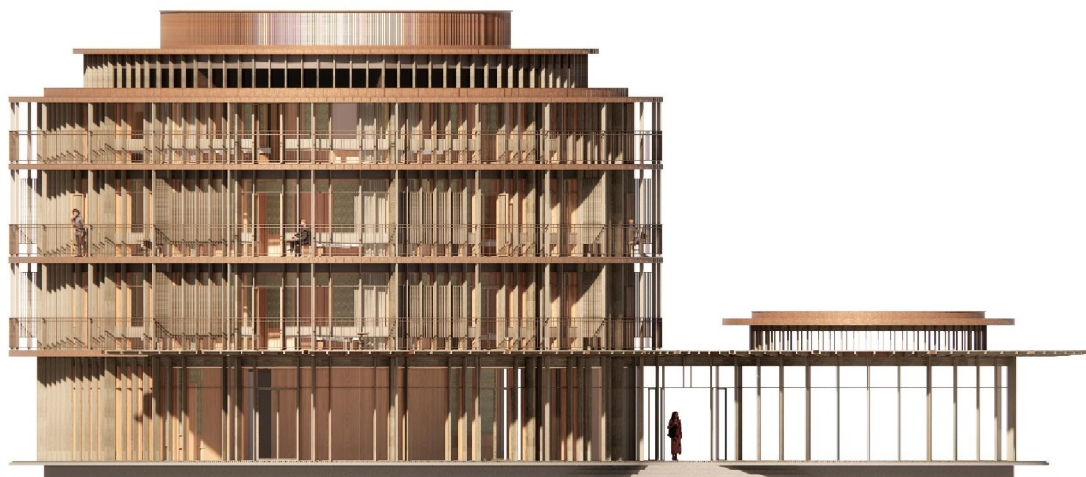
Nya Moriska och nya Gubbhyllan föreslås utföras med fasader av träelement med transparenta glasfält och tätta partier med beklädnad av vertikala trälameller och balkonger som löper längs med byggnadernas fasader. Bilden visar Nya Gubbhyllan. Den mindre byggnadsdelen till höger föreslås innehålla servering. Källa: Lundgaard & Tranberg Arkitekter
