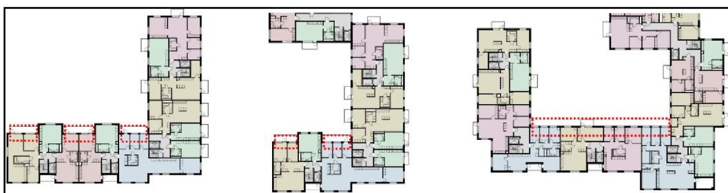
Figur 5. Markering av rum mot tyst sida i lägenheter som överskrider 60 dBA ekvivalent ljudnivå.
