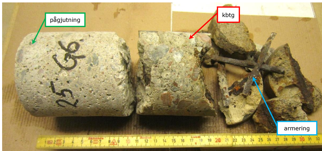
Utborrade kärna 25:G6 (för skadad för att tryckprova)
