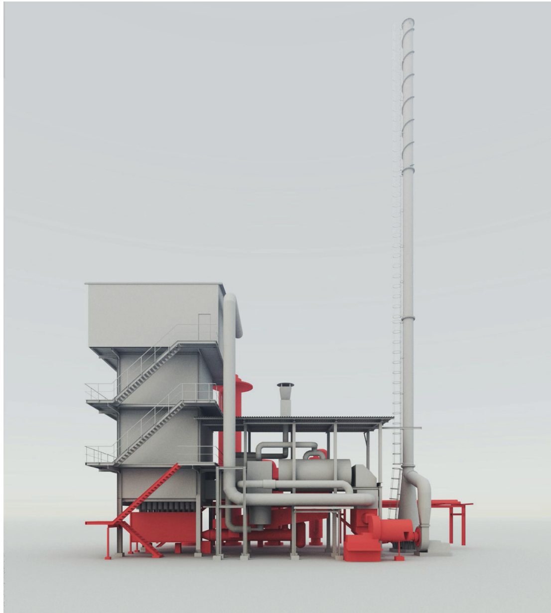
Visualisering av 3D-modell som visar spaltgasverkets huvudsakliga delar. Rödmarkerade delar föreslås tas bort
