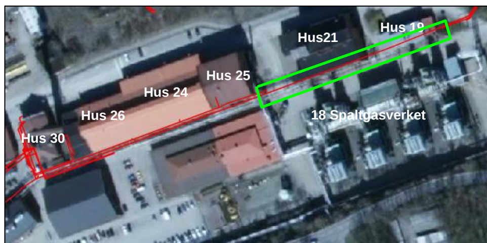
Figur 6. Lokalisering av tjärledning. Tjärledningen öster om hus 25 har rivits och marken kring ledningen är sanerad, se grön markering.
