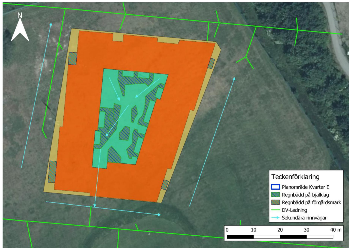
Figur 6-6. Sekundära avrinningsvägar för kvarter E, Årstafältet.
