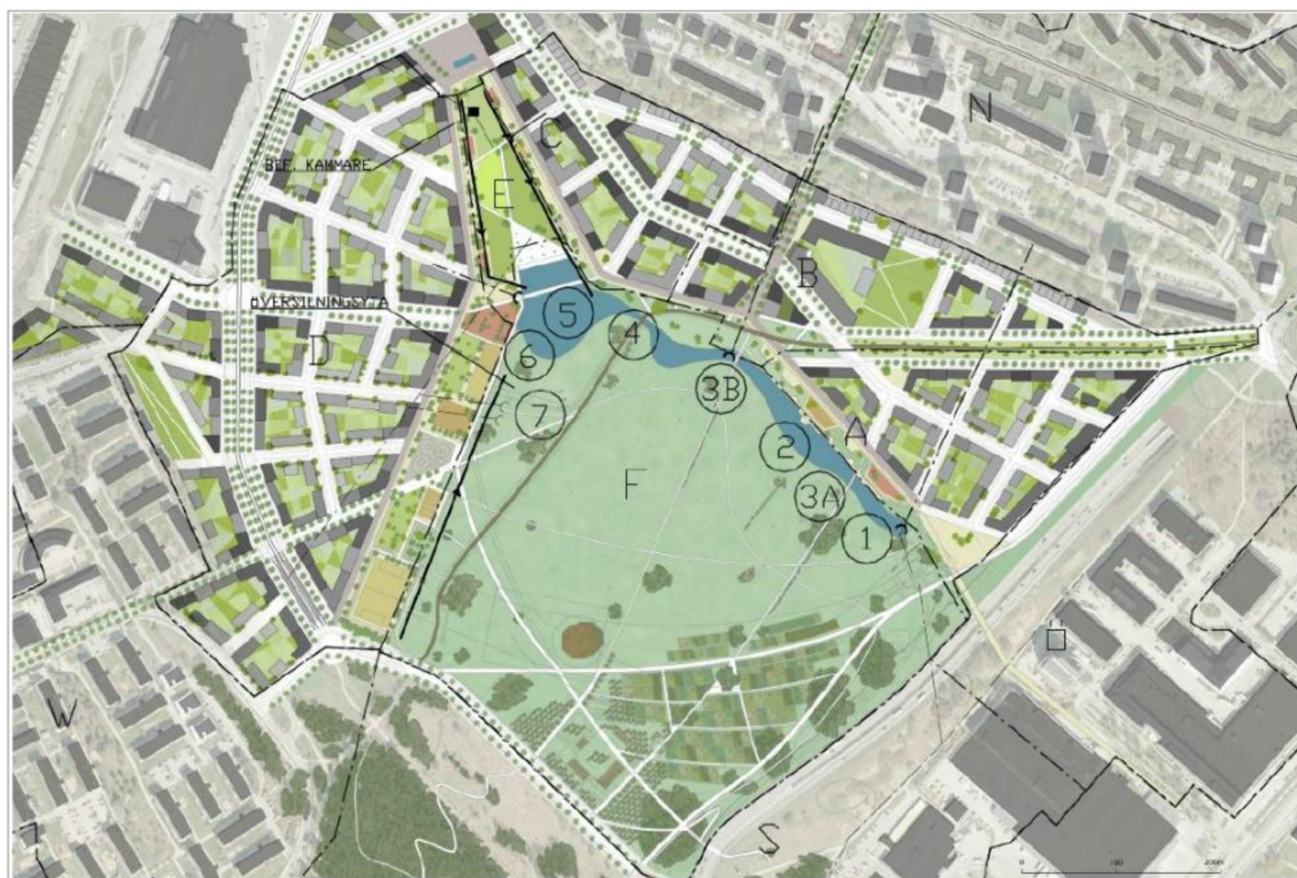
Figur 3-1. Avrinningsområden för planerad exploatering av Årstafälten. Planområdet Kvarter E innefattas av delavrinningsområdet D, där dagvatten leds mot Valla Å, vidare mot Valla damm (5). Figur från Sweco (2012).
