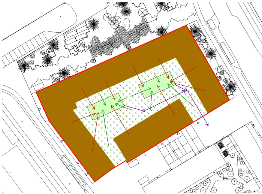
Figur 11. Konceptuell illustration av dagvattenavledningen till växtbäddar. Röda pilar visar avledning av takvatten där taken lutar in mot innergården och vattnet avleds via stuprör och vidare ytligt från utkastare till växtbädden. Gröna pilar visar avledning av gårdsvatten samt lila pilar visar dagvattenledning från växtbäddarna ut mot servisen.
